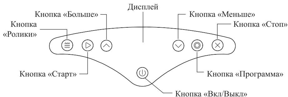
**Кнопка «Вкл/Выкл»** включает и выключает массажер. При включении прибор переходит в режим ожидания и на дисплее отображается надпись «НА» (ручная настройка).
