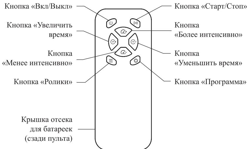
Вы можете управлять работой прибора с помощью пульта ДУ, направляя его на корпус массажера. Пульт ДУ питается от 2 батареек типоразмера AAA × 1,5 В.
