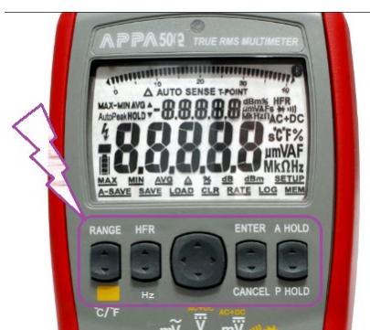
Рис. 6.2. Функциональные кнопки APPA502 (указаны стрелкой)
