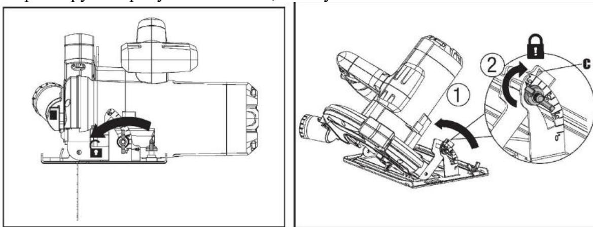
**ПРИМЕЧАНИЕ!** При пилении под наклоном значение глубины пропила, устанавливаемое по шкале, не совпадает с истинным значением. Глубина пропила в этом случае равна перпендикуляру от вершины самого низкого зуба к плоскости платформы.
