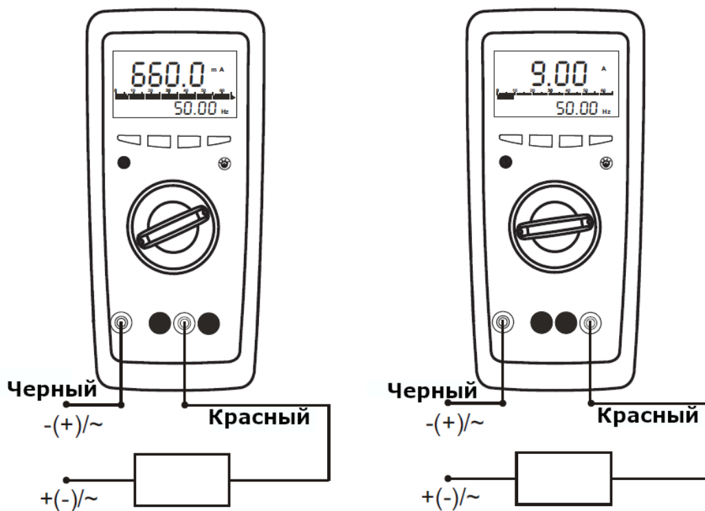
Рис. 6.2 Схема подключения при измерении силы тока
