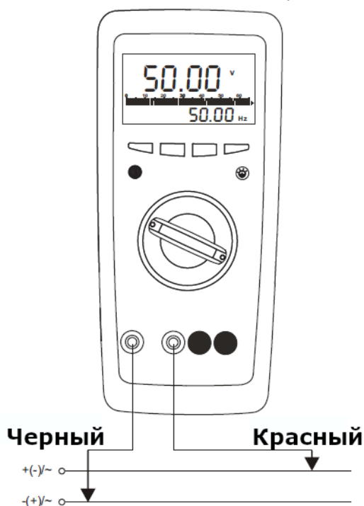
Рис. 6.1 Схема подключения при измерении напряжения
