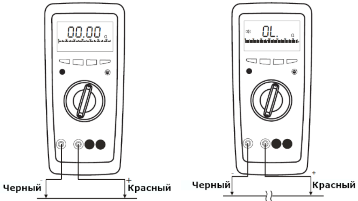
Рис. 6.5 Схема подключения для звуковой прозвонки цепи
