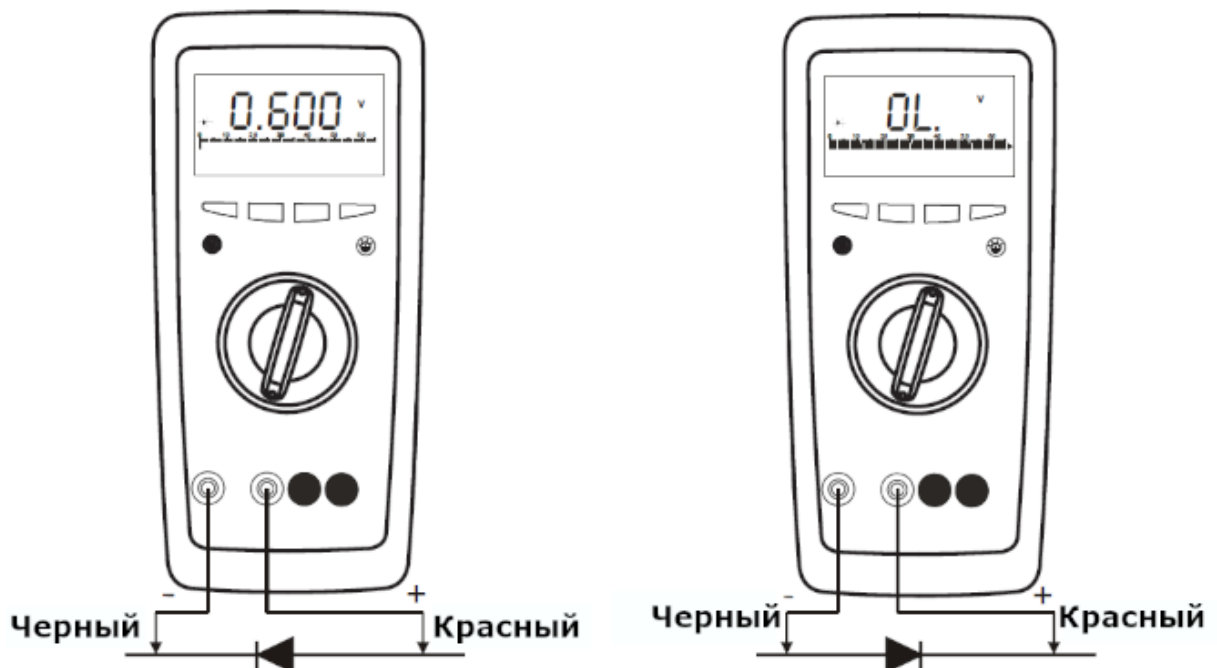
Рис. 6.6 Схема подключения в режиме испытания p-n переходов
