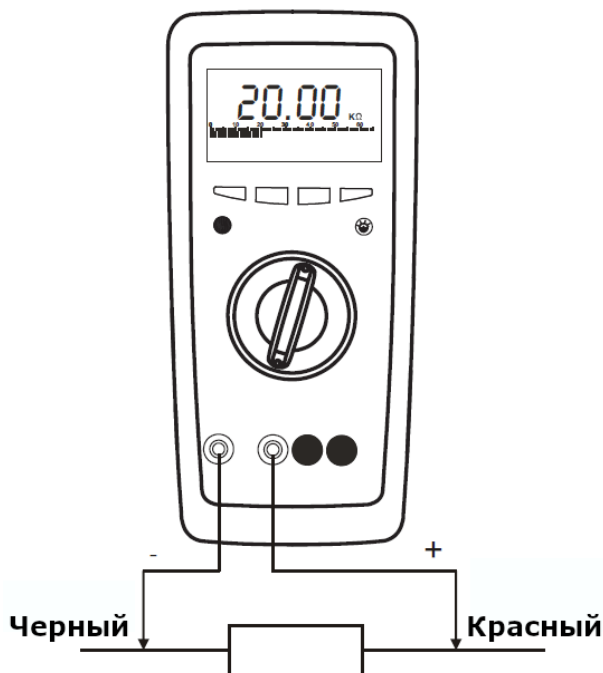
Рис. 6.4 Схема подключения при измерении сопротивления
