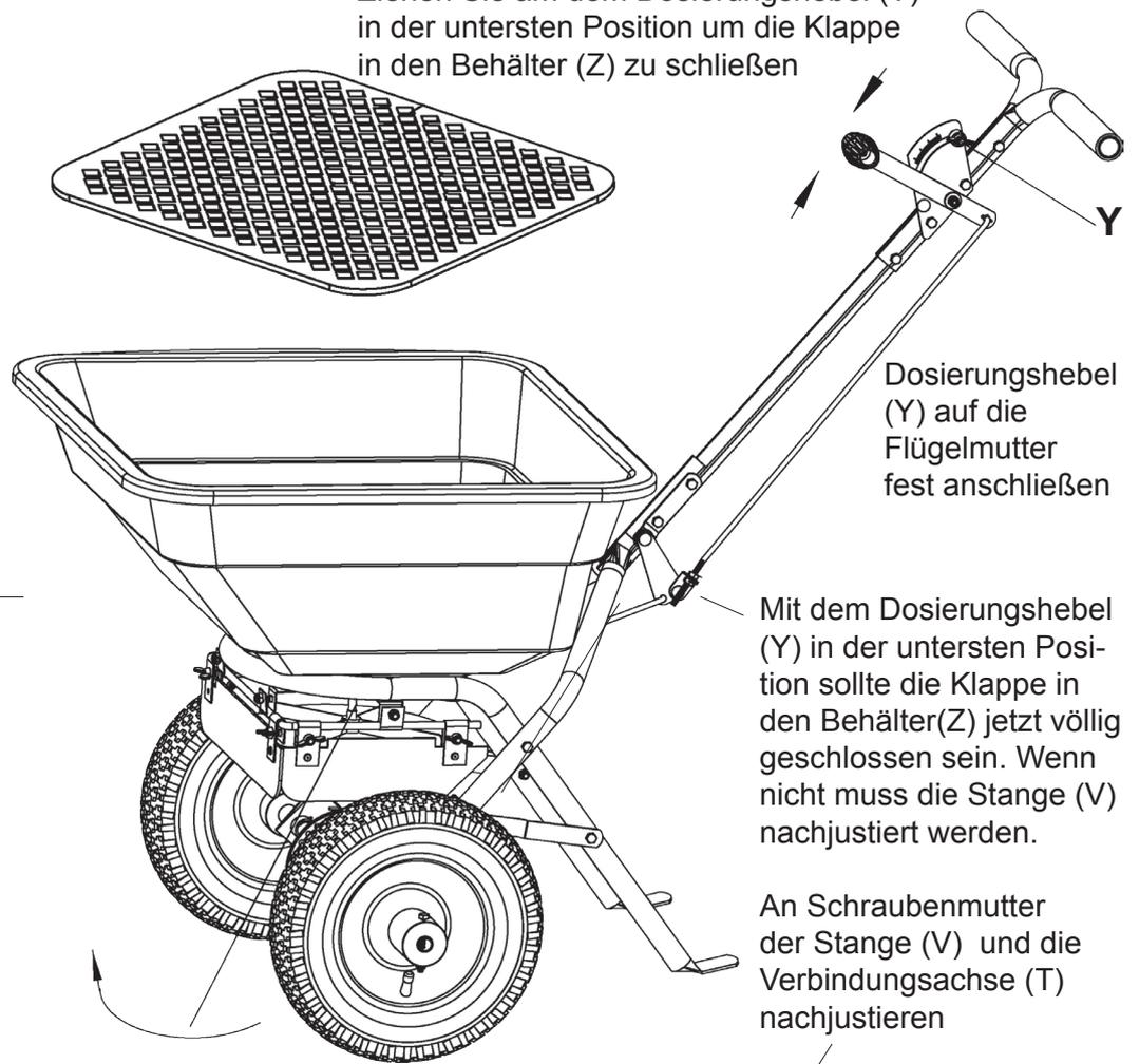
Dosierungshebel (Y) auf die Flügelmutter fest anschließen
