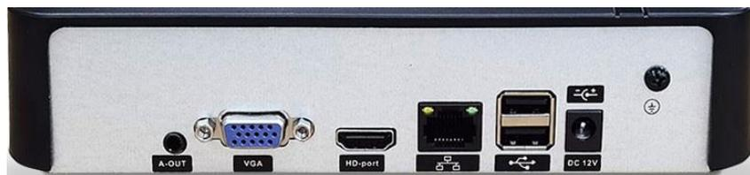
Рис. 1. Расположение разъемов на задней панели Прибора
