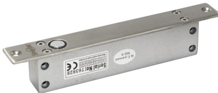
Электромеханический соленоидный замок ST-DB410MT предназначен для работы в составе систем контроля доступа с электронным управлением блокировкой дверей. Замок ST-DB410MT является нормально-открытым, т.е. разблокируются при отключении питания и блокируются при его наличии. Для мониторинга положения створки двери в системе контроля доступа можно использовать соответствующий выход замка.
