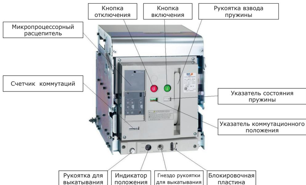
**Рисунок 2** – Лицевая панель выключателя серии OptiMat A-S2 – OptiMat A-S6
