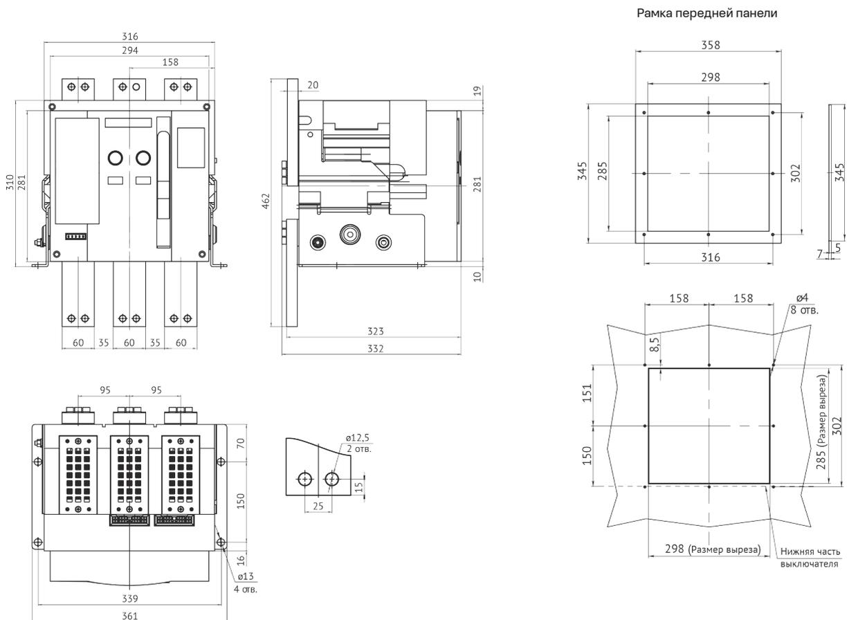
**Автоматический выключатель OptiMat A-2500-3200-S4-3P стационарного исполнения на номинальные токи 2500-3200 А с задним горизонтальным и вертикальным расположением выводов**
