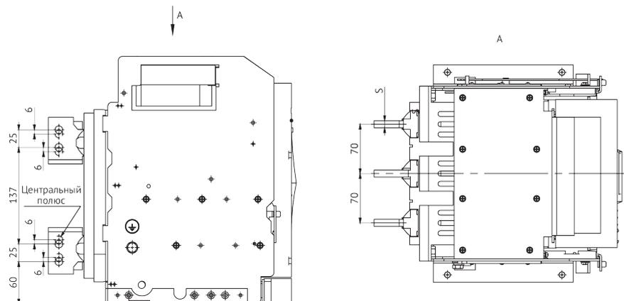
**Автоматический выключатель OptiMat A-1600-S1-3P выдвигного исполнения на номинальный ток 1600 А с задним горизонтальным расположением выводов с установленными расширителями полюсов**
