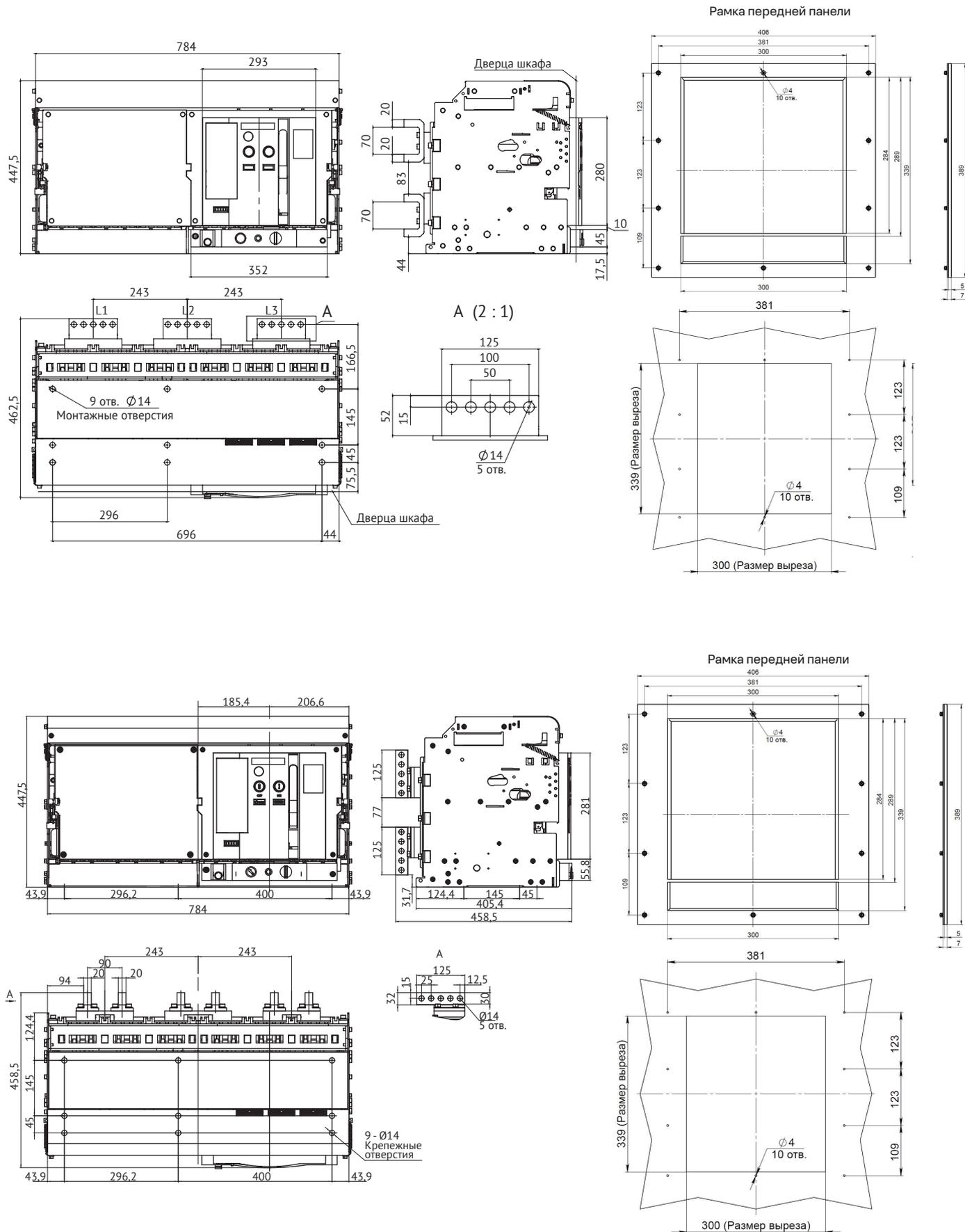
Автоматический выключатель OptiMat A-5000-S6-4P-150кА выдвижного исполнения на номинальный ток 5000 А, ПКС 150 кА с задним горизонтальным и вертикальным расположением выводов
