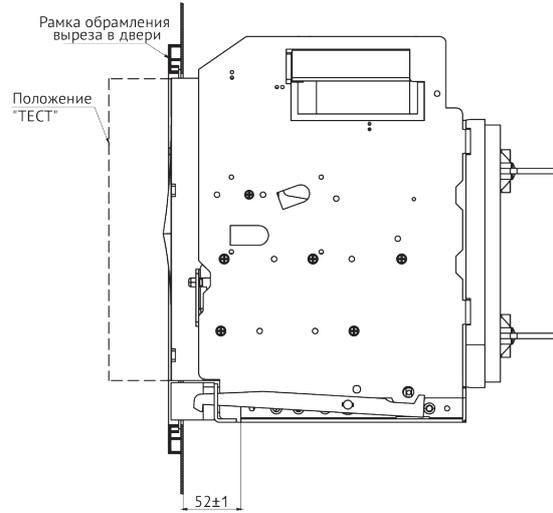
S1 выдвижного типа с установленной рамкой (вид сбоку)
