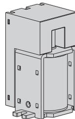
Катушка включения предназначена для дистанционного включения автоматического выключателя. Унифицирован для выключателей OptiMat A габаритного исполнения S2, S4, S6 (150 кА). Устанавливается под лицевой панелью автоматического выключателя в собственную ячейку.
