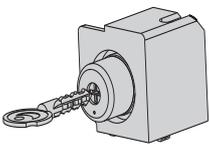
Встраиваемый замок включения предназначен для блокировки включения (блокирует выключатель в отключенном состоянии). Разблокировать выключатель без соответствующего ключа невозможно. Устройство унифицировано для выключателей OptiMat A габаритного исполнения S2, S4, S6 (150 кА). Устанавливается под лицевой панелью автоматического выключателя в собственную ячейку.
