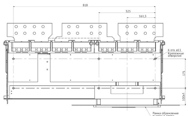
S6 выдвижного типа с установленной рамкой (вид сверху)
