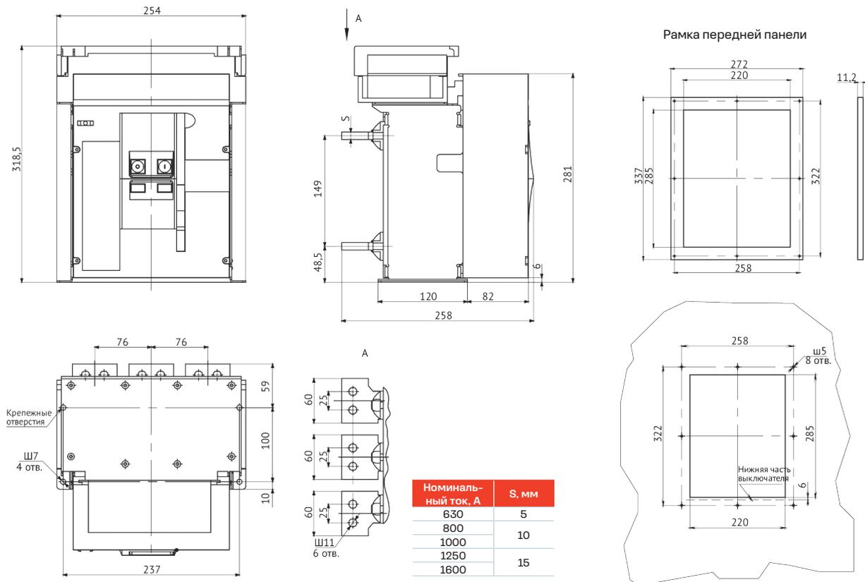
Автоматический выключатель OptiMat A-1600-S1-3P стационарного исполнения на номинальный ток 1600 А с задним горизонтальным расположением выводов с установленными расширителями полюсов
