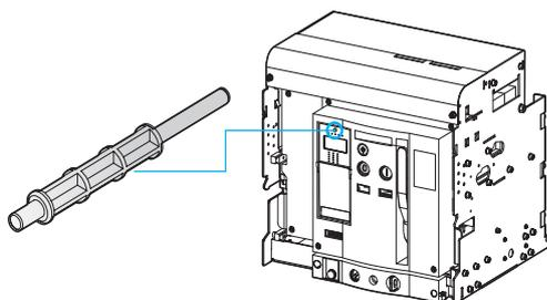
Модуль в основании микропроцессорного расцепителя оснащен кнопкой ручного возврата в исходное состояние после срабатывания от микропроцессорного расцепителя. При срабатывании автоматического выключателя кнопка выдвигается вперед. Для включения автоматического выключателя необходимо нажать кнопку. Унифицирован для выключателей OptiMat A габаритного исполнения S2, S4, S6 (150 кА). Устанавливается под лицевой панелью автоматического выключателя в собственную ячейку. Входит в базовую комплектацию.
