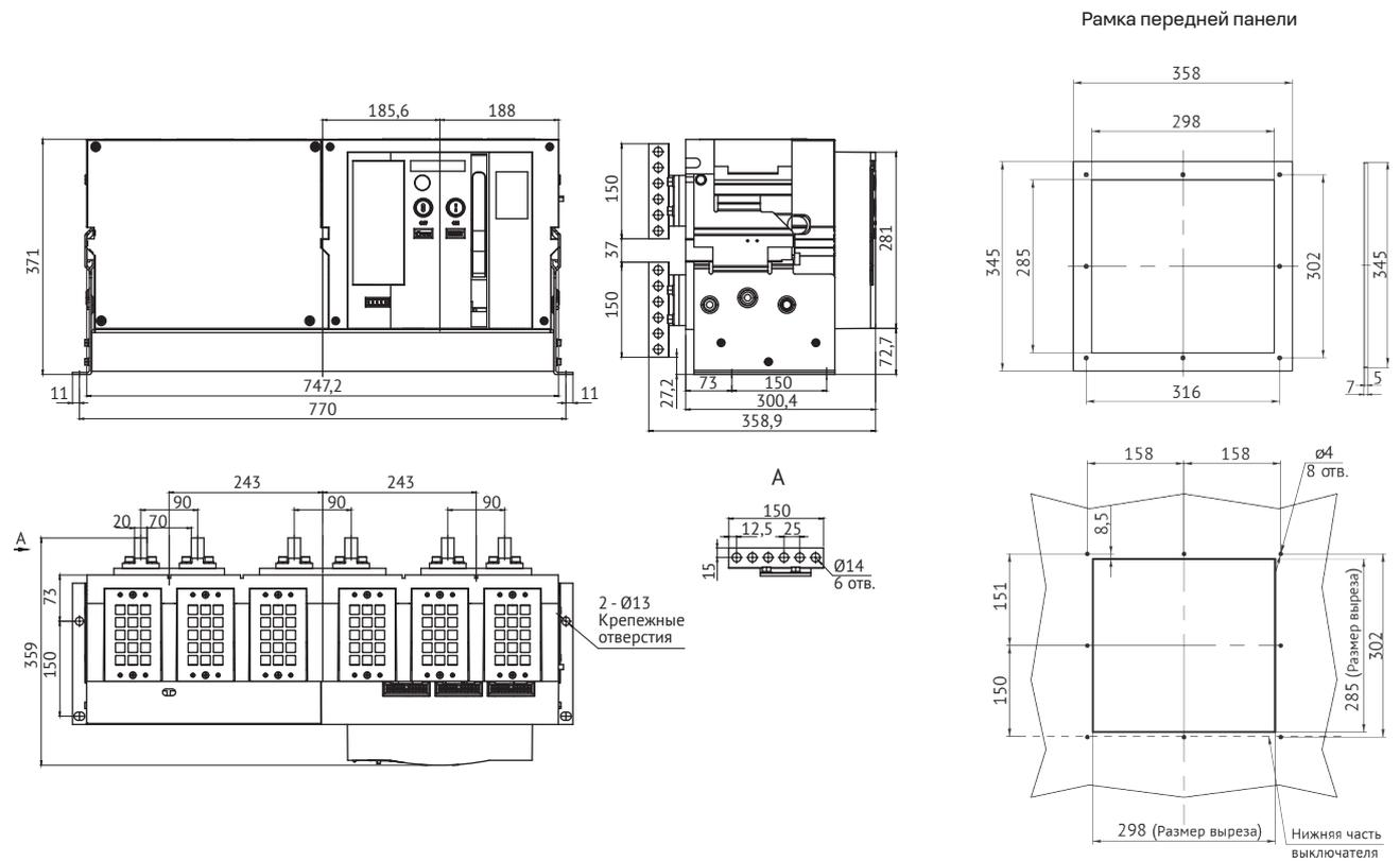
Автоматический выключатель OptiMat A-6300-S6-4P-150кА стационарного исполнения на номинальный ток 6300 А, ПКС 150 кА с задним горизонтальным и вертикальным расположением выводов
