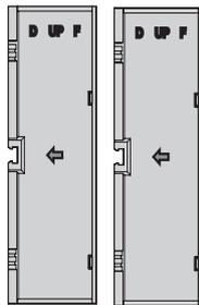
Межполюсные перегородки предназначены для предотвращения образования межфазного короткого замыкания. Устройства унифицированы для выключателей OptiMat A габаритного исполнения S2, S4, S6 (150 кА). Устанавливаются в соответствующие пазы между главными выводами выключателя. Входят в базовую комплектацию.
