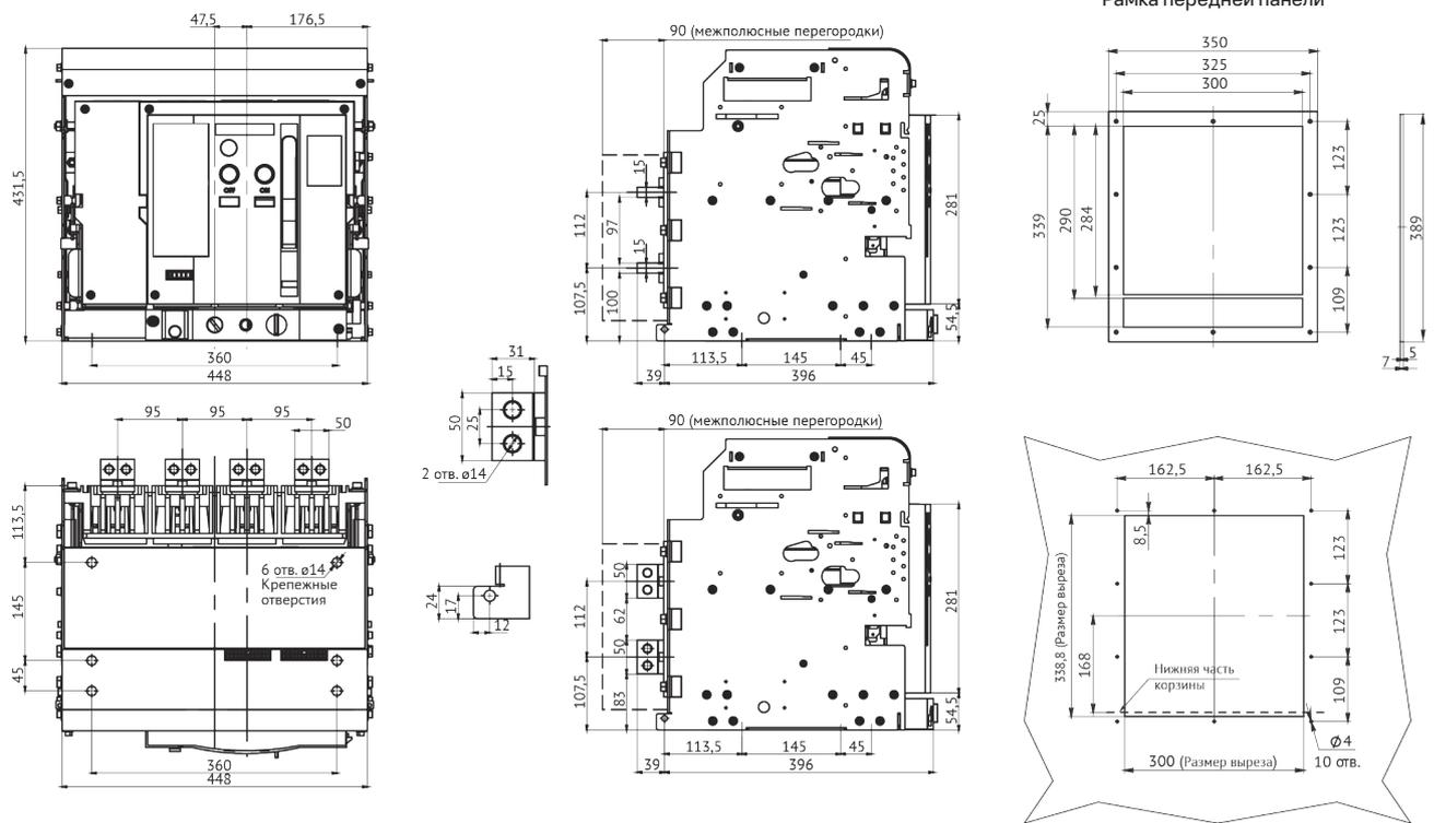
**Автоматический выключатель OptiMat A-2000-S2-3P выдвигного исполнения на номинальный ток 2000 А с задним вертикальным расположением выводов**
