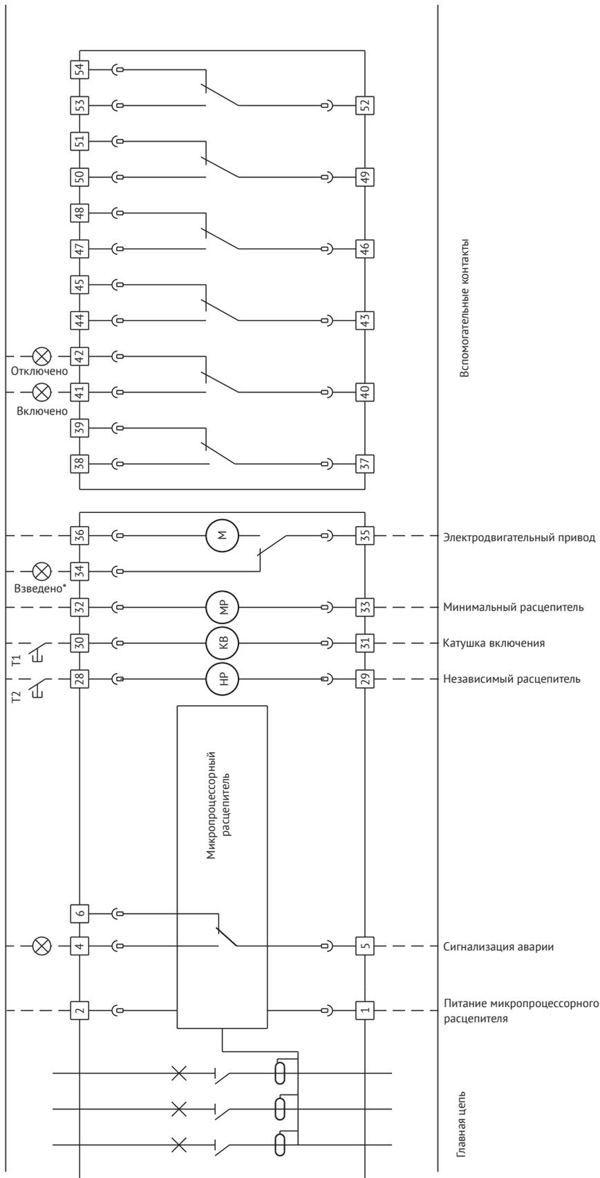
\*Выход "34" (звездено) гальванически не развязан с выводом "36"
