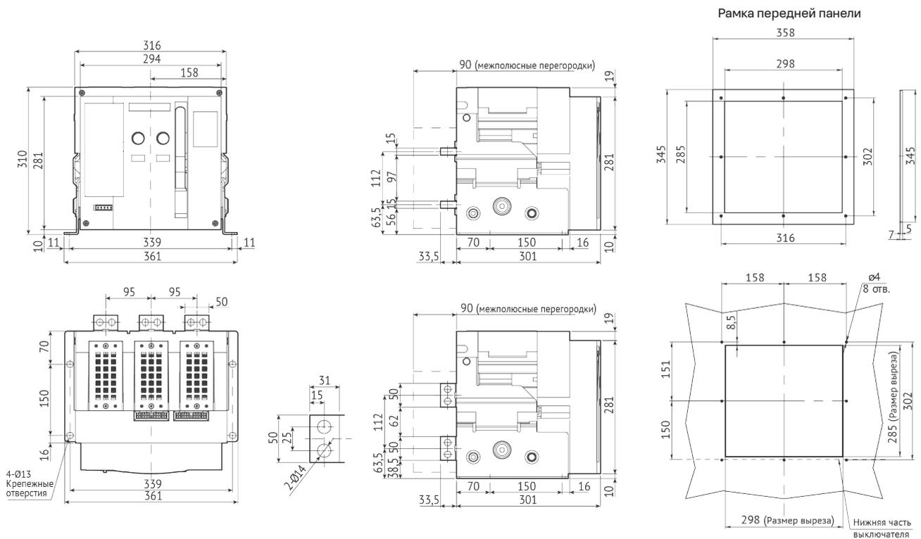
**Автоматический выключатель OptiMat A-630-1600-S2-4P стационарного исполнения на номинальные токи 630–1600 А с задним вертикальным и горизонтальным расположением выводов**
