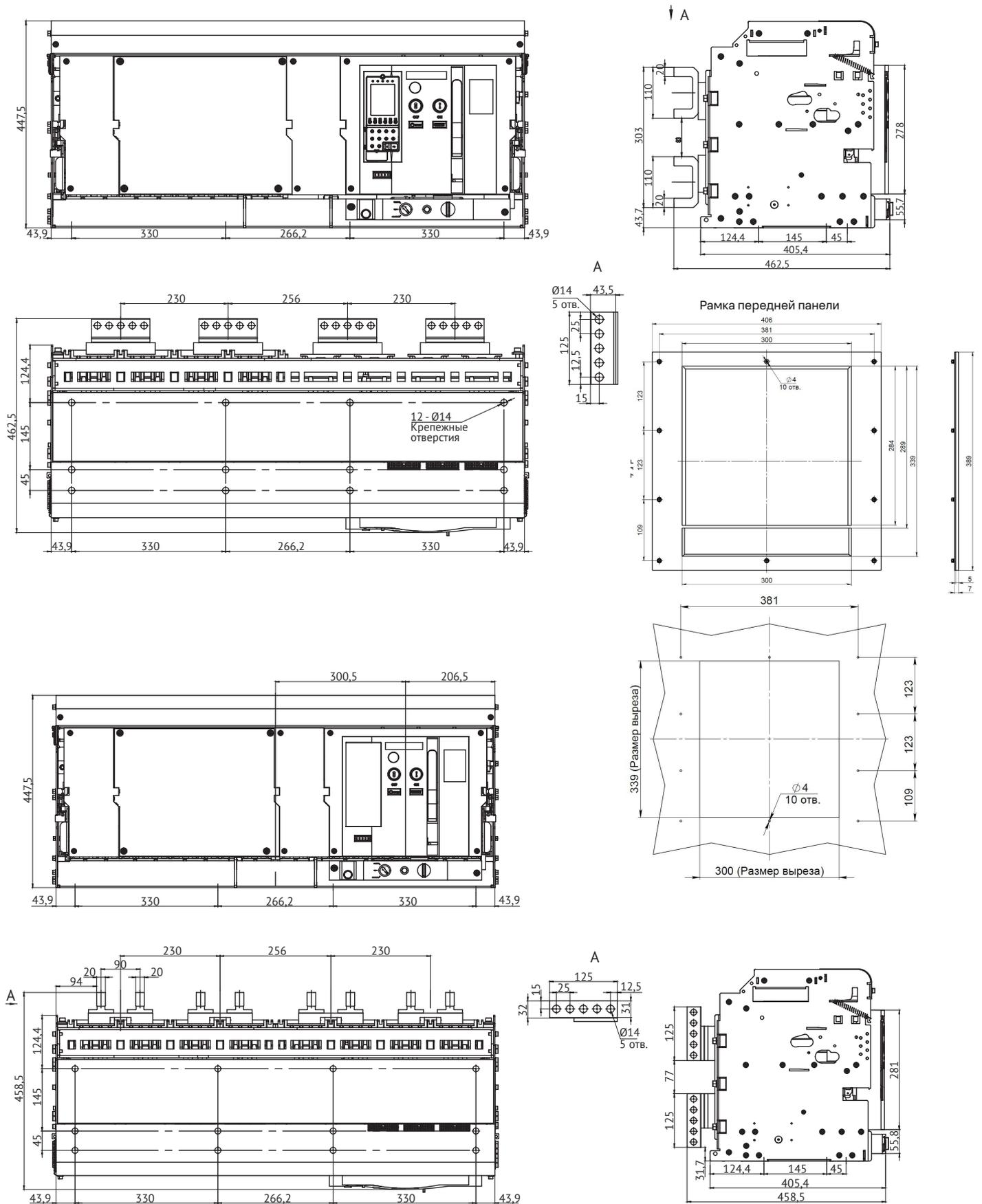
Автоматический выключатель OptiMat A-6300-S6-3P-150кА выдвижного исполнения на номинальный ток 6300 А, ПКС 150 кА с задним горизонтальным и вертикальным расположением выводов
