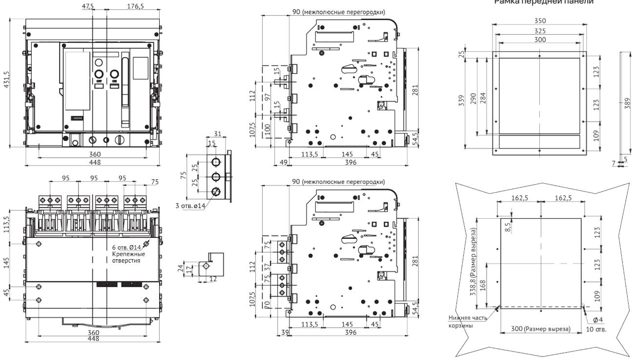
**Автоматический выключатель OptiMat A-630-2000-S2-3P выдвигного исполнения на номинальные токи 630–2000 А с передним расположением выводов**
