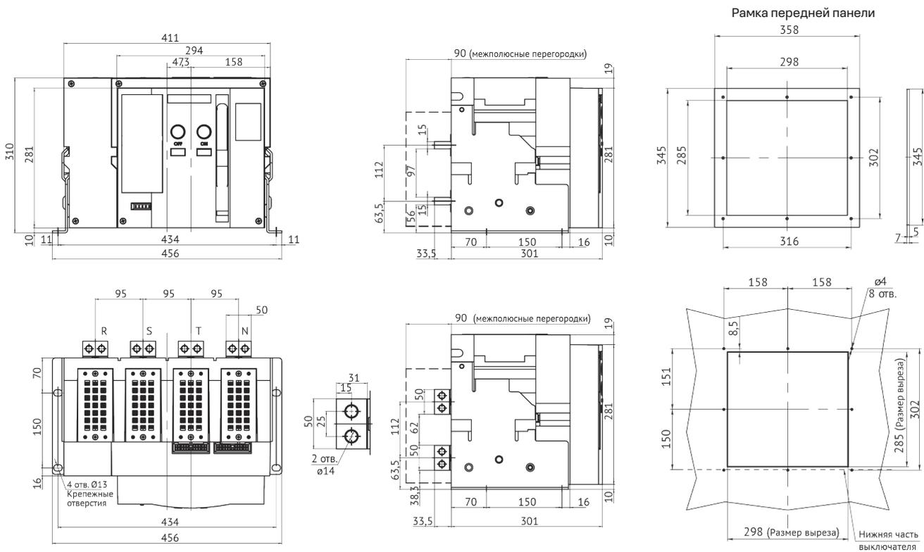
**Автоматический выключатель OptiMat A-2000-S2-3P стационарного исполнения на номинальный ток 2000 А с задним вертикальным расположением выводов**
