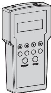
Тестер микропроцессорных расцепителей автоматических выключателей серии OptiMat A предназначен для тестирования микропроцессорных расцепителей серий MR7.0, MR8.0, MR8.1. Тестирование осуществляется путем подключения к разъемам расцепителя и позволяет провести проверку работы аппарата в аварийных режимах и целостности внутренней электрической цепи.
