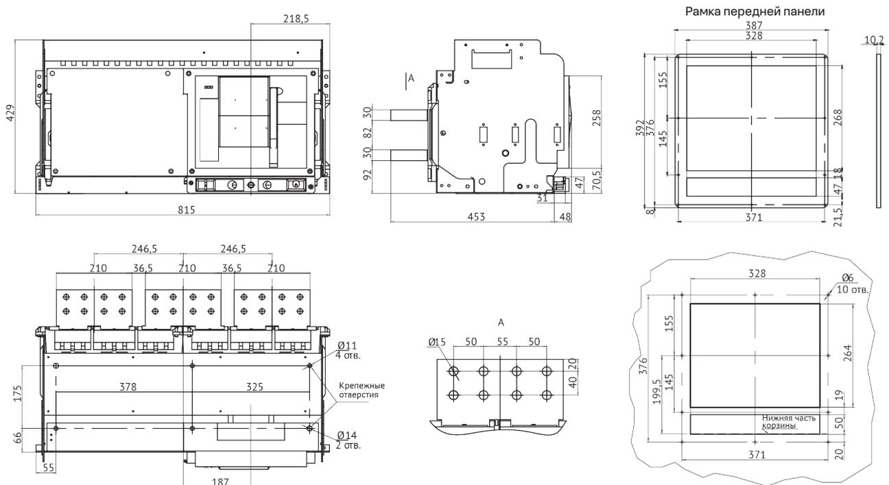
Автоматический выключатель OptiMat A-5000-S6-3P-150кА выдвижного исполнения на номинальный ток 5000 А, ПКС 150 кА с задним горизонтальным и вертикальным расположением выводов
