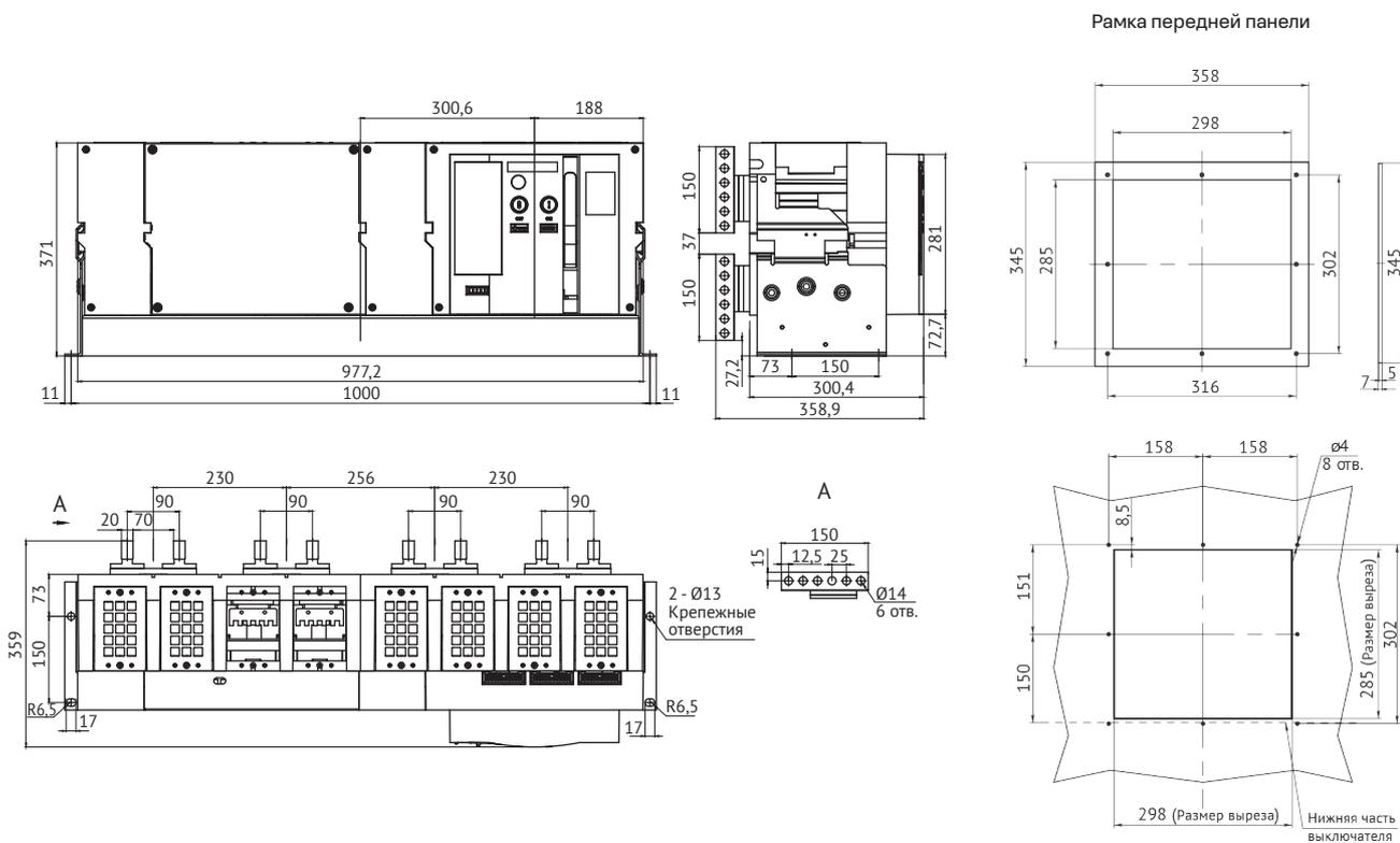
**Автоматический выключатель OptiMat A-630-1600-S1-3P выдвигного исполнения на номинальные токи 630–1600 А с задним горизонтальным расположением выводов**
