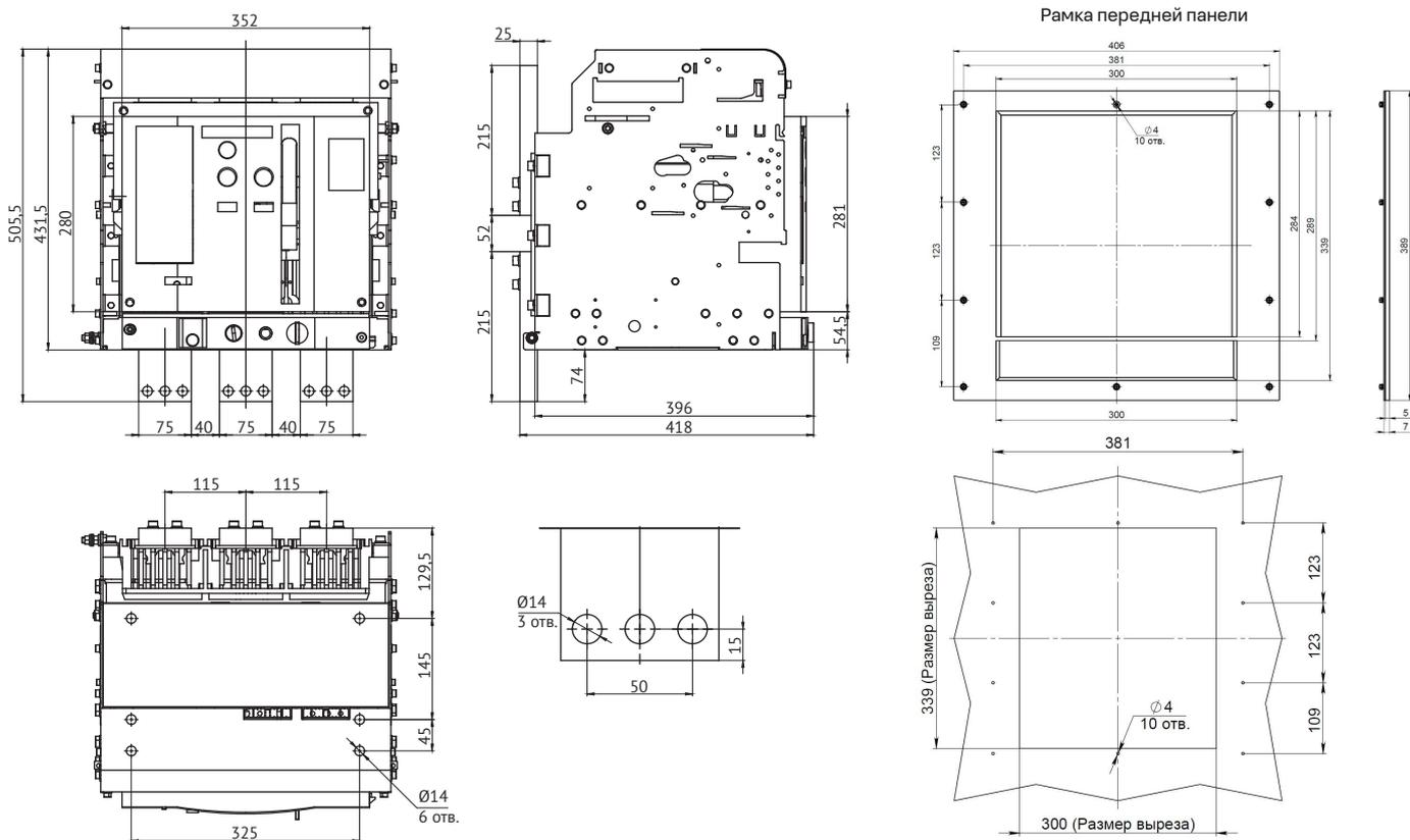
**Автоматический выключатель OptiMat A-2500-S4-4P выдвижного исполнения на номинальный ток 2500 А с передним расположением выводов**
