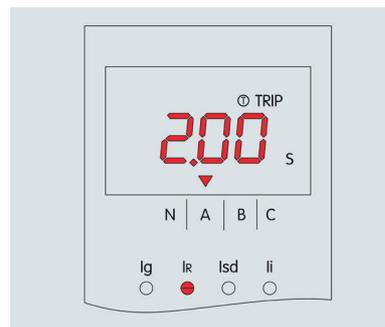
Чтобы перейти к состоянию моделирования срабатывания при BIR, нажмите кнопку «test». После срабатывания можно посмотреть следующие данные.
