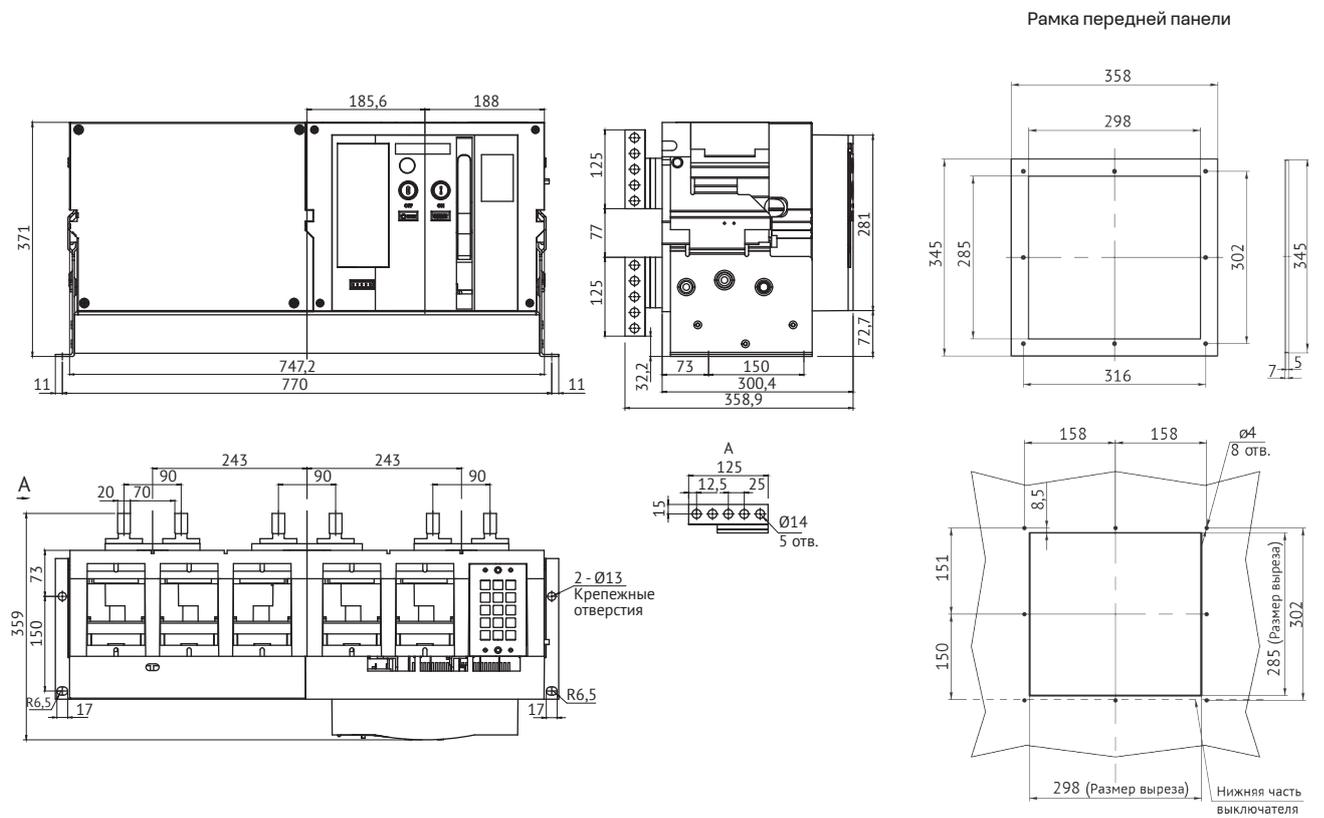
Автоматический выключатель OptiMat A-5000-S6-4P-150кА стационарного исполнения на номинальный ток 5000 А, ПКС 150 кА с задним горизонтальным и вертикальным расположением выводов
