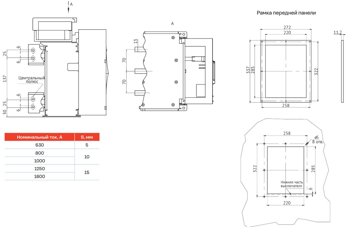
**Автоматический выключатель OptiMat A-630-1600-S2-3P стационарного исполнения на номинальные токи 630–1600 А с задним вертикальным и горизонтальным расположением выводов**
