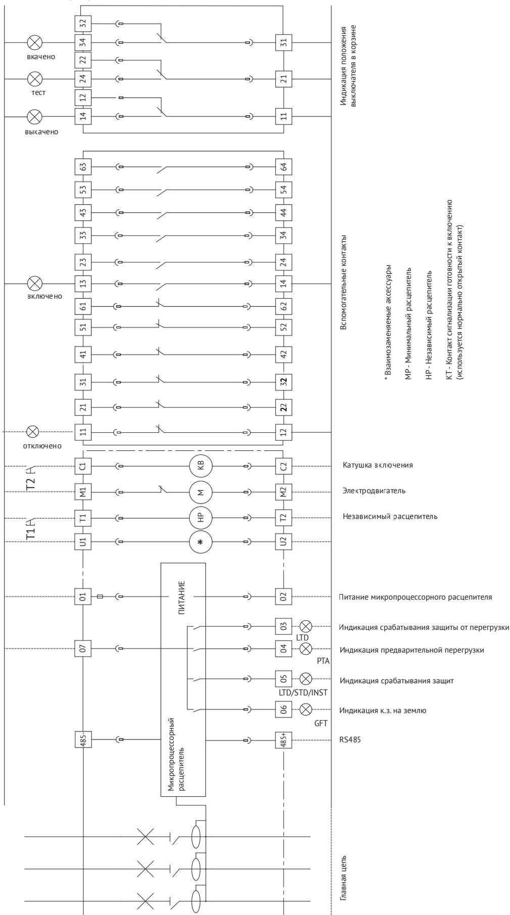
Принципиальная электрическая схема выключателя с полупроводниковым расцепителем типа MR8.1 габаритного исполнения S2, S4, S6
