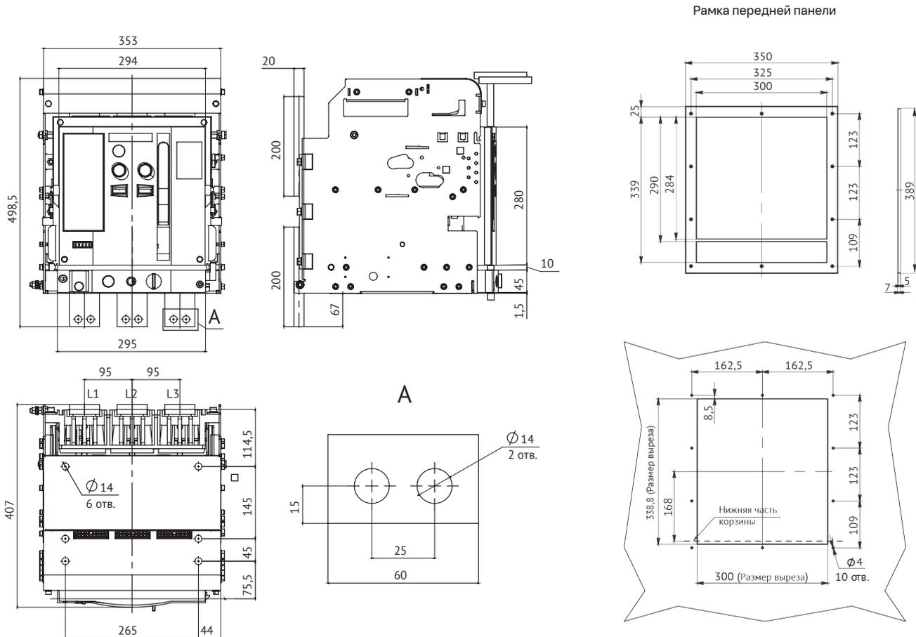
**Автоматический выключатель OptiMat A-630-2000-S2-4P выдвигного исполнения на номинальные токи 630–2000 А с передним расположением выводов**
