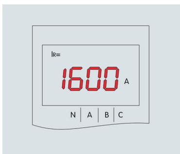
Чтобы перейти к запросу какой установлен параметр для защиты от сверхтока, нужно нажать кнопку «→».
