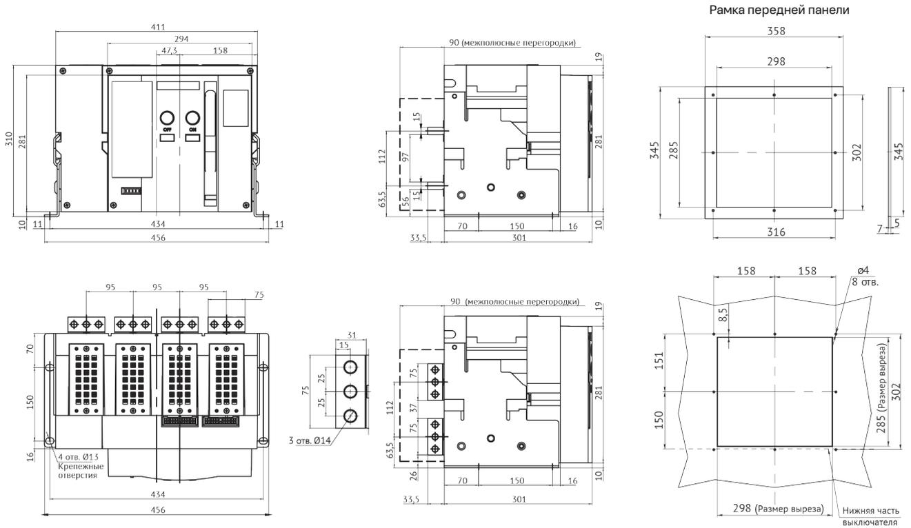
**Автоматический выключатель OptiMat A-630-2000-S2-3P стационарного исполнения на номинальные токи 630–2000 А с передним расположением выводов**
