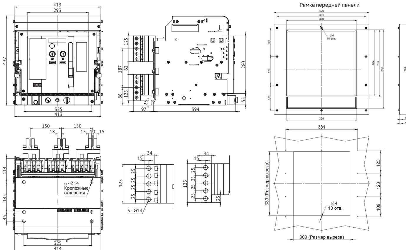
**Автоматический выключатель OptiMat A-4000-S4-4P выдвигного исполнения на номинальный ток 4000 А с задним вертикальным расположением выводов**
