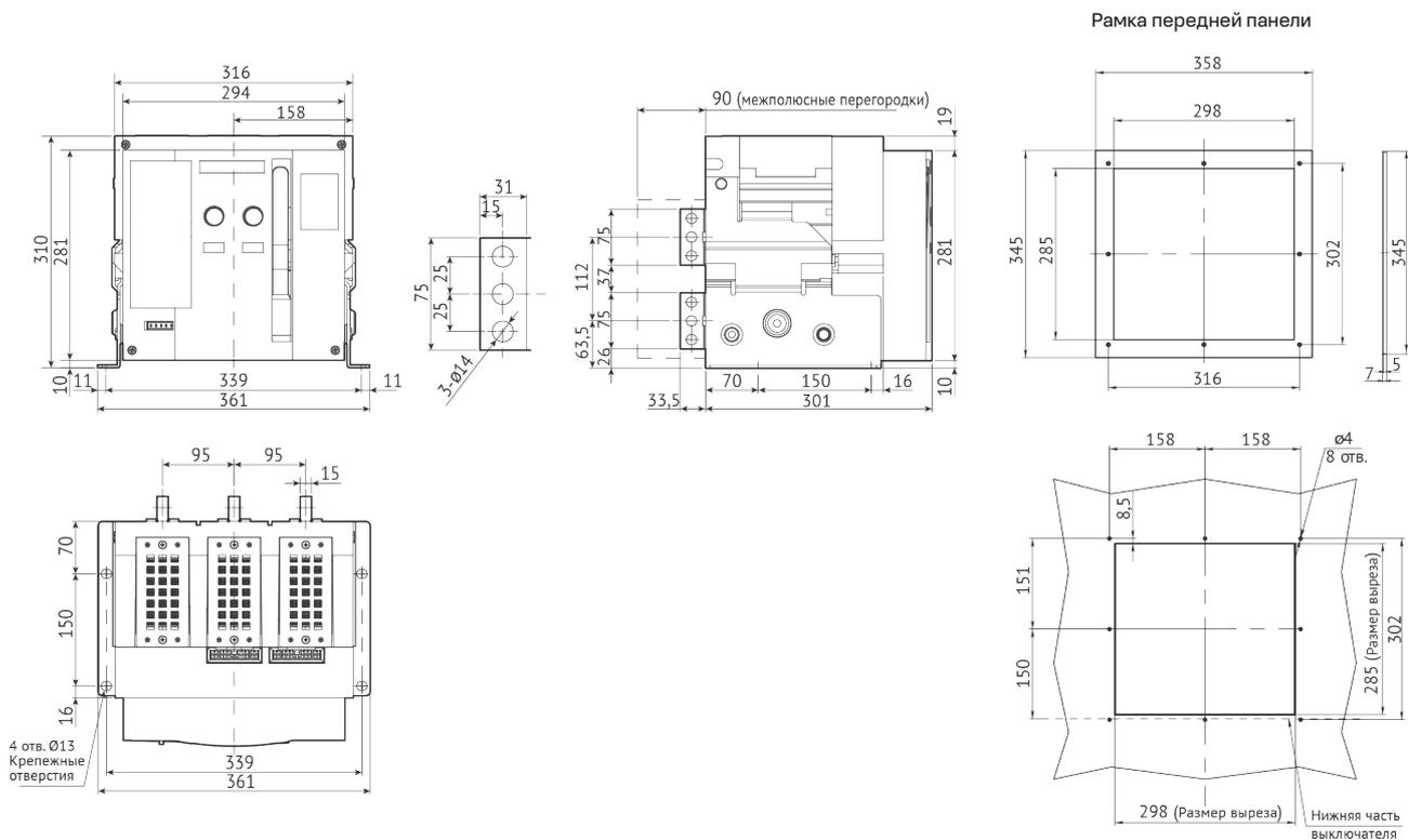
**Автоматический выключатель OptiMat A-2000-S2-4P стационарного исполнения на номинальный ток 2000 А с задним вертикальным и горизонтальным расположением выводов**
