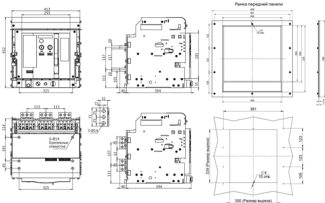
**Автоматический выключатель OptiMat A-2500-3200-S4-4P выдвигного исполнения на номинальные токи 2500-3200 А с задним горизонтальным и вертикальным расположением выводов**
