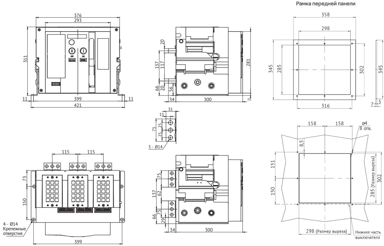
**Автоматический выключатель OptiMat A-2500-3200-S4-4P стационарного исполнения на номинальные токи 2500-3200 А с задним горизонтальным и вертикальным расположением выводов**
