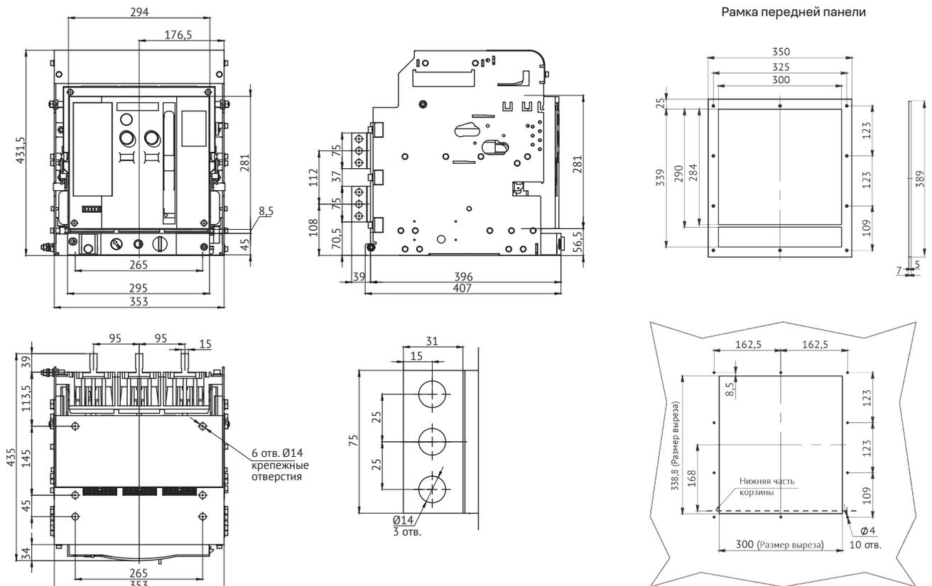
**Автоматический выключатель OptiMat A-2000-S2-4P выдвигного исполнения на номинальный ток 2000 А с задним вертикальным расположением выводов**
