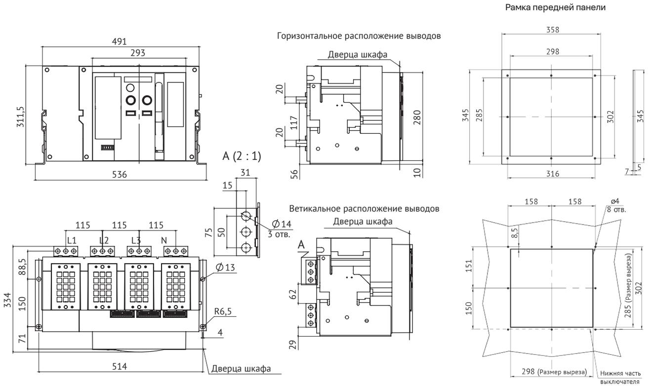
**Автоматический выключатель OptiMat A-2500-S4-3P стационарного исполнения на номинальный ток 2500 А с передним расположением выводов**
