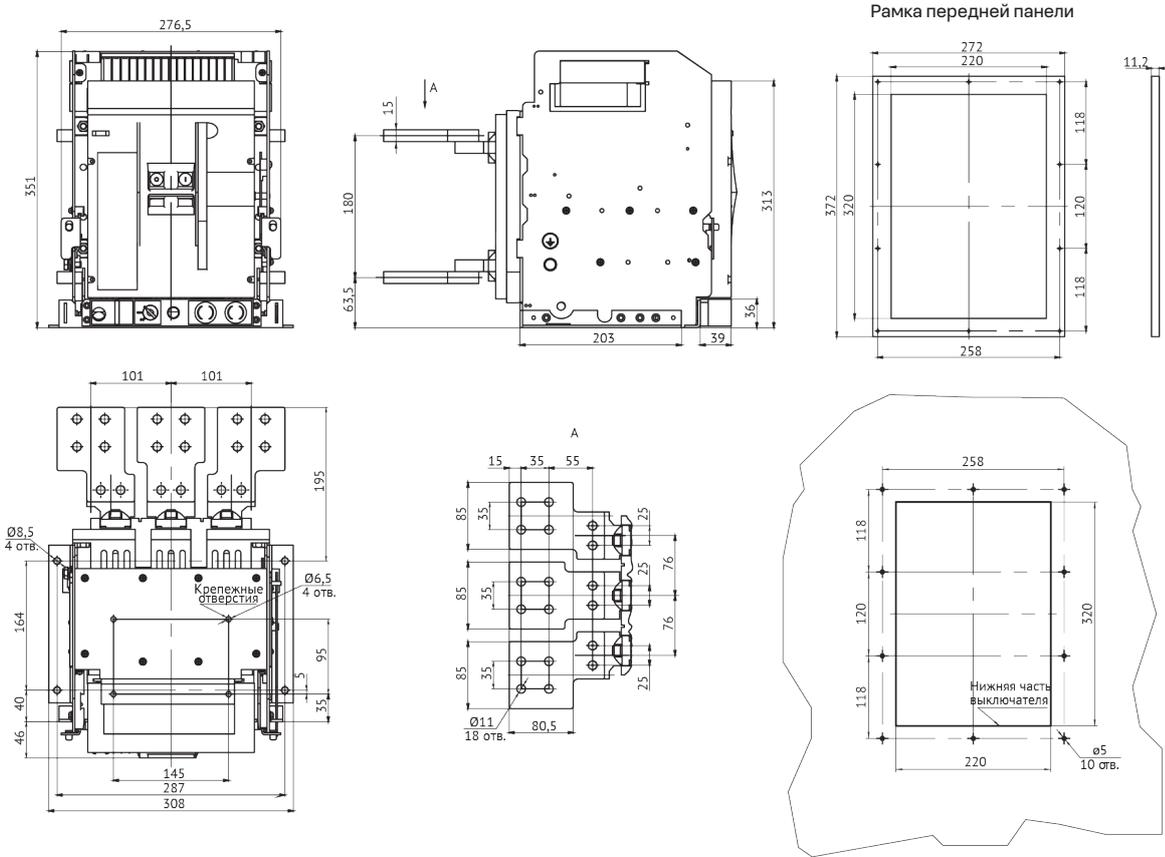
**Автоматический выключатель OptiMat A-630-1600-S2-3P выдвигного исполнения на номинальные токи 630–1600 А с задним вертикальным и горизонтальным расположением выводов**
