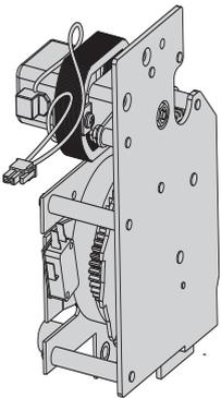
Двигательный привод предназначен для взвода включающей пружины автоматического выключателя. При отсутствии питания двигательного привода взвод включающей пружины производится вручную. Устройство унифицировано для выключателей OptiMat A габаритного исполнения S2, S4, S6 (150 кА). Устанавливается под лицевой панелью автоматического выключателя в собственную ячейку.
