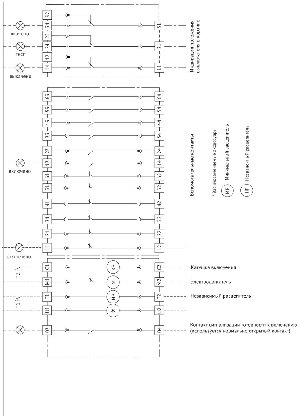
**Принципиальная электрическая схема выключателя с полупроводниковым расцепителем типа MR7.0 габаритного исполнения S2, S4, S6**
