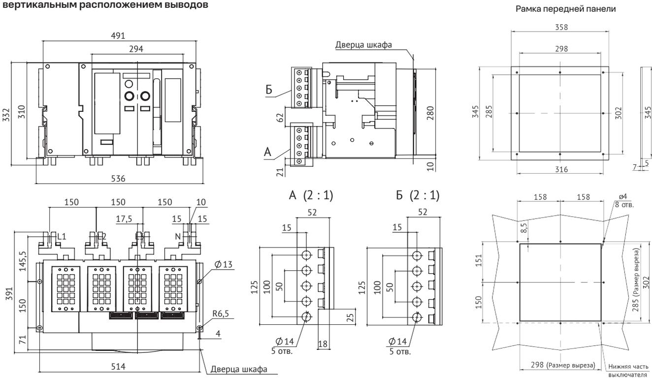
Автоматический выключатель OptiMat A-5000-S6-3P-150кА стационарного исполнения на номинальный ток 5000 А, ПКС 150 кА с задним горизонтальным и вертикальным расположением выводов
