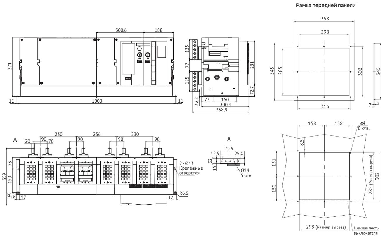
Автоматический выключатель OptiMat A-6300-S6-3P-150кА стационарного исполнения на номинальный ток 6300 А, ПКС 150 кА с задним горизонтальным и вертикальным расположением выводов
