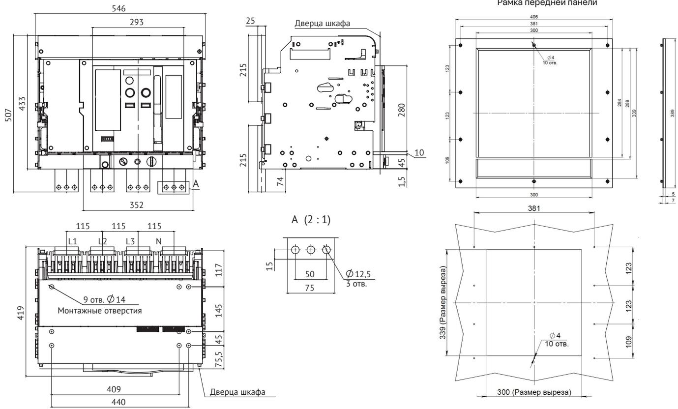
**Автоматический выключатель OptiMat A-4000-S4-3P выдвижного исполнения на номинальный ток 4000 А с задним вертикальным расположением выводов**
