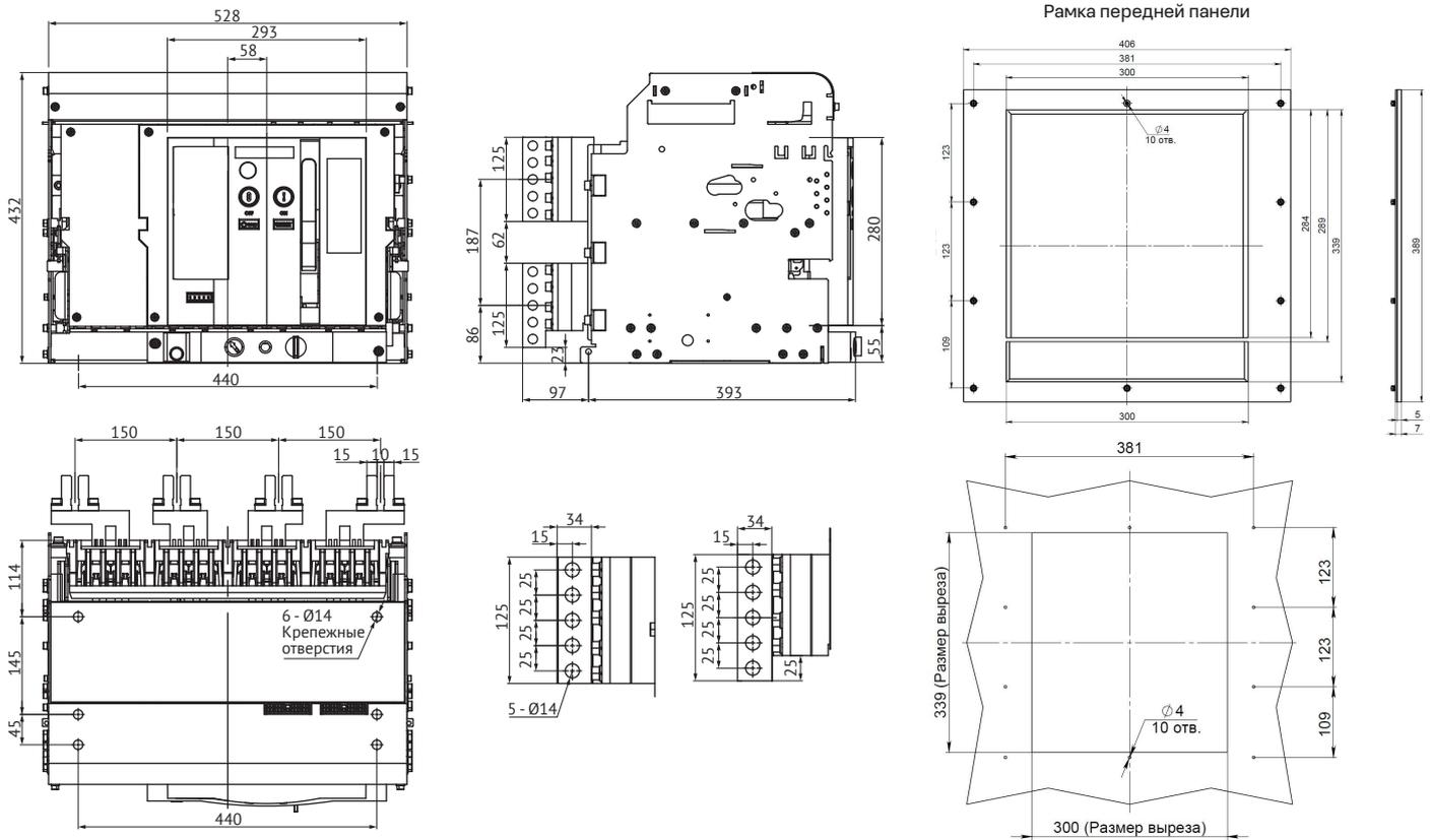
**Автоматический выключатель OptiMat A-5000-S5-3P выдвигного исполнения на номинальный ток 5000 А с задним горизонтальным расположением выводов**
