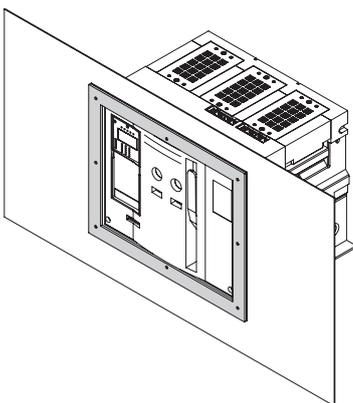
Рамка передней панели предназначена для повышения степени защиты от прикосновения к острой кромке выреза. Кроме того, она защищает выступающую переднюю часть выключателя. Устанавливается на переднюю панель распределительного устройства. Рамки передней панели входят в базовую комплектацию.
