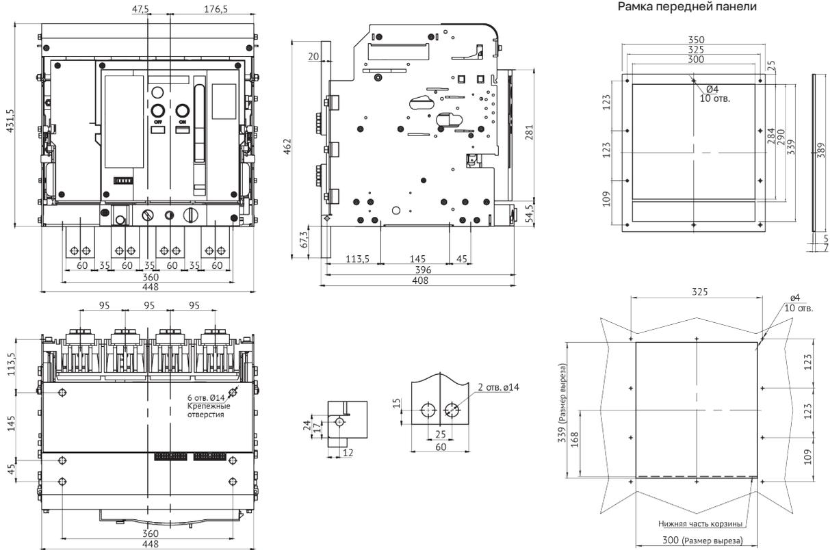
**Автоматический выключатель OptiMat A-2500-3200-S4-3P выдвигного исполнения на номинальные токи 2500–3200 А с задним горизонтальным и вертикальным расположением выводов**
