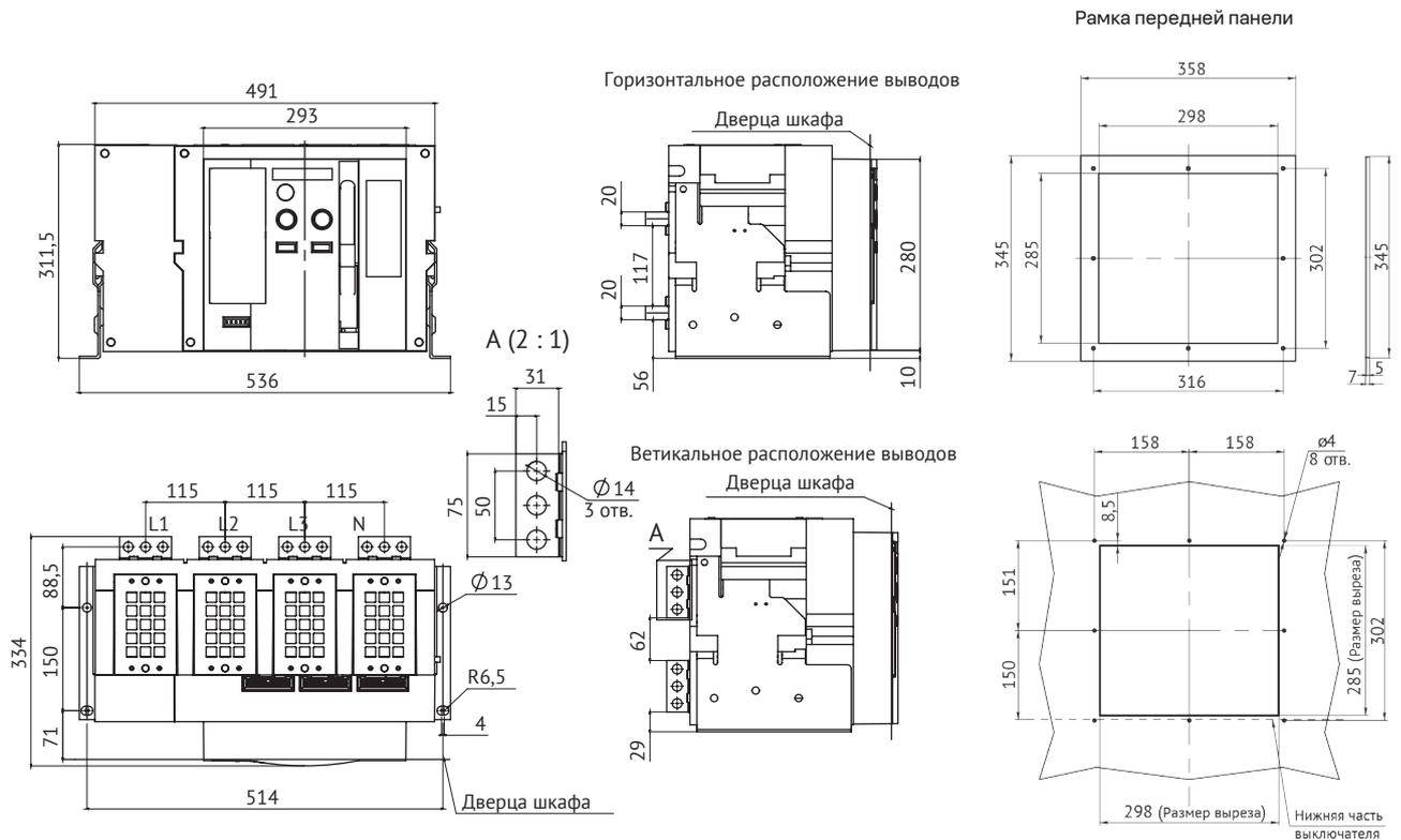
**Автоматический выключатель OptiMat A-4000-S4-3P стационарного исполнения на номинальный ток 4000 А с задним вертикальным расположением выводов**
