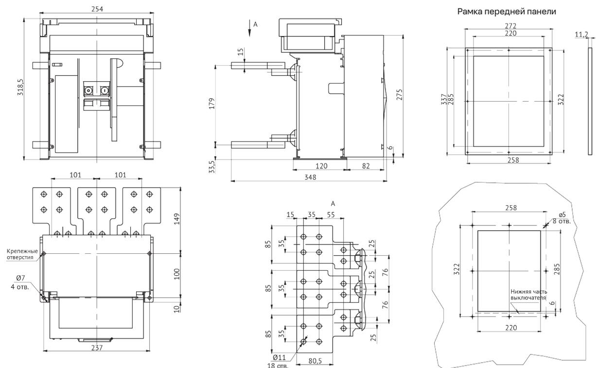
**Автоматический выключатель OptiMat A-630-1600-S1-3P стационарного исполнения на номинальные токи 630–1600 А с задним вертикальным расположением выводов**
