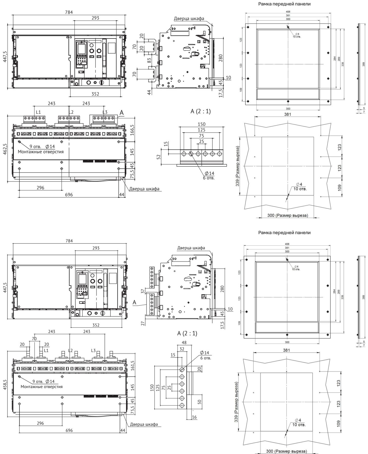
Автоматический выключатель OptiMat A-6300-S6-4P-150кА выдвижного исполнения на номинальный ток 6300 А, ПКС 150 кА с задним горизонтальным и вертикальным расположением выводов
