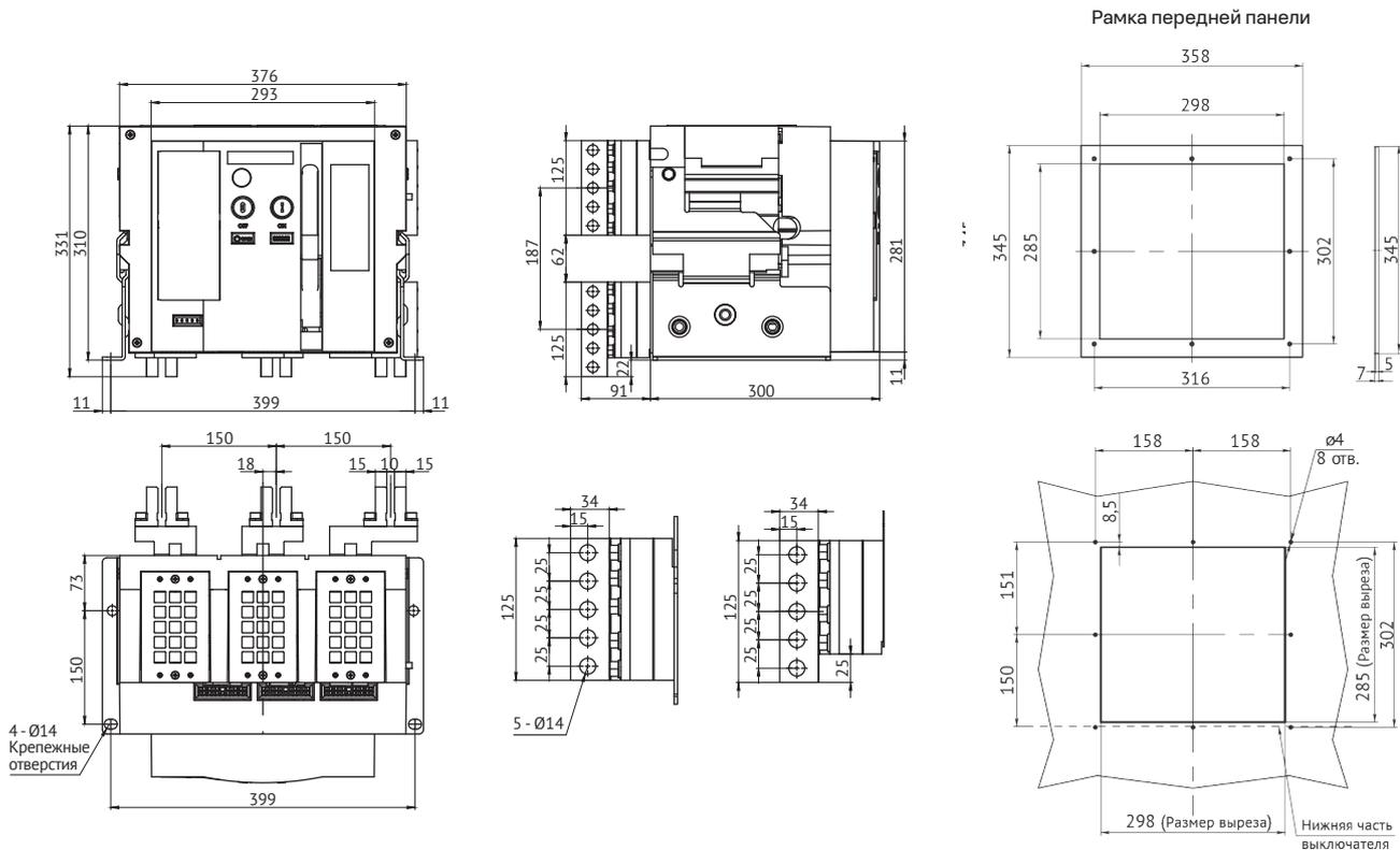
**Автоматический выключатель OptiMat A-4000-S4-4P стационарного исполнения на номинальный ток 4000 А с задним вертикальным расположением выводов**
