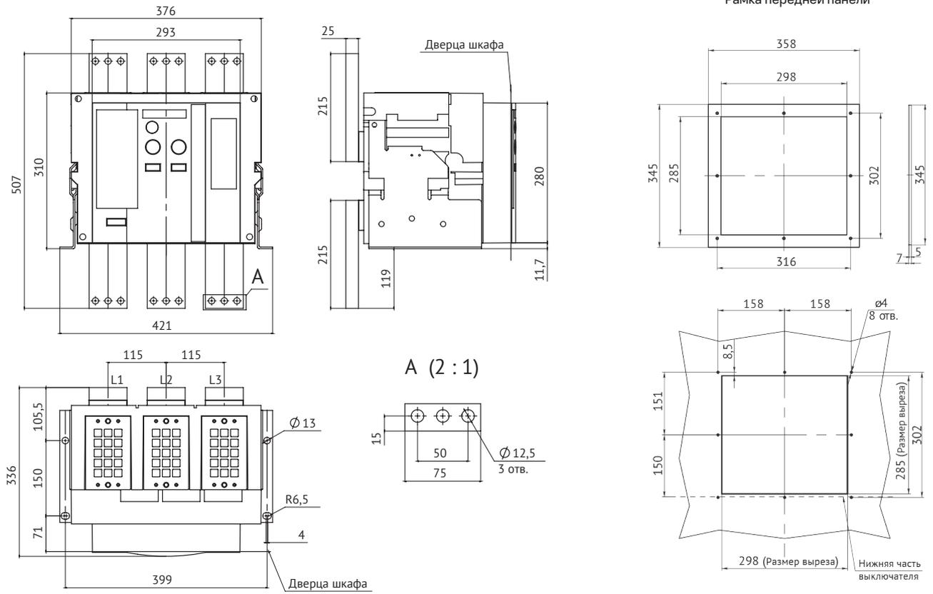
**Автоматический выключатель OptiMat A-2500-S4-4P стационарного исполнения на номинальный ток 2500 А с передним расположением выводов**
