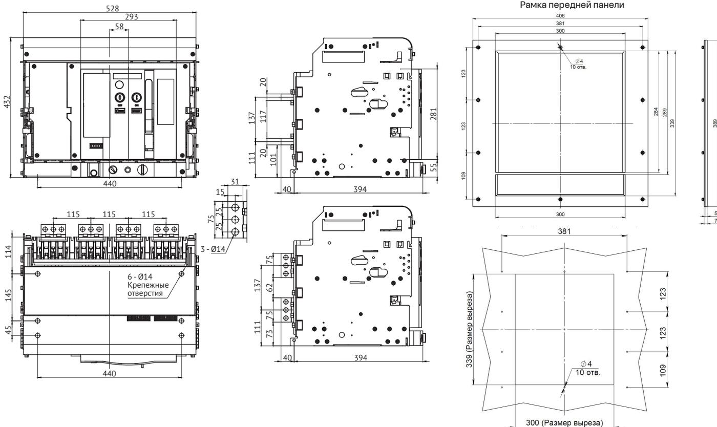
**Автоматический выключатель OptiMat A-2500-S4-3P выдвигного исполнения на номинальный ток 2500 А с передним расположением выводов**
