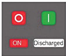
выключатель включен и включающие пружины не взведены
