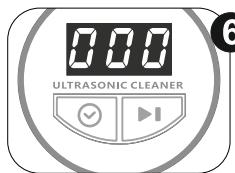
**6** Когда отсчет на таймере достигнет нуля, процесс очистки автоматически остановится и на дисплее появится надпись **000**.
