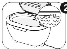
**2** Заполните бак водопроводной водой. Жидкость должна покрывать очищаемые детали, но не превышать отметку "MAX".
