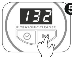
**5** Нажмите кнопку "**On/Off**" для запуска процесса очистки. На таймере начнется обратный отсчет времени работы.
