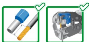
Длина снятия изоляции зависит от геометрии наконечника, разъема или контактной клеммы в точке подключения и определяется по месту монтажа.
