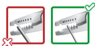
При использовании ручных или полуавтоматических стрипперов с многопозиционными режущими лезвиями правильно выбирайте размер калибровочного отверстия.
