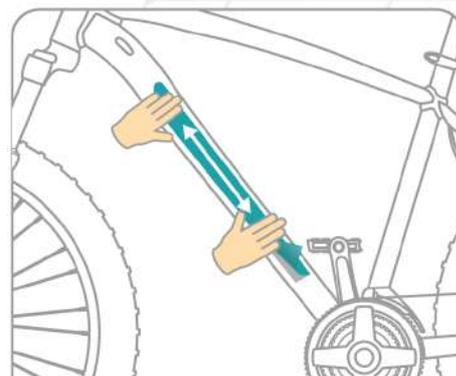
6. Нанести пленку на деталь, позиционируя наклейку на поверхности
