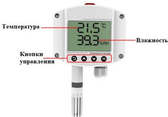
Датчики температуры и влажности ТН-20 могут иметь монохромный дисплей с отображением текущей температуры и влажности воздуха. Модели с дисплеем имеют артикулы, заканчивающиеся на букву "D". В моделях с интерфейсом RS485 на дисплее можно производить настройку сетевых параметров интерфейса RS485, а именно: Slave ID и скорость обмена. Также на дисплее возможно сделать корректировку показаний температуры и влажности, а также ввести
