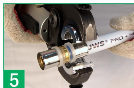
5 Инструмент заводится на фитинг таким образом, чтобы буртик гильзы вошёл в соответствующее углубление пресс-насадки. Несоблюдение этого правила приводит к порче фитинга, некачественному соединению и поломке инструмента!
