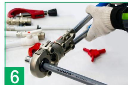
6 Смыканием рукояток производится опрессовка гильзы. Инструмент требует регулировки в соответствии с инструкцией производителя для правильного обжима фитинга!
