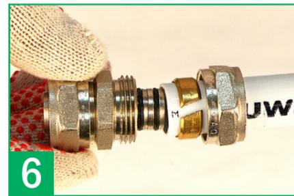
6 Слегка прокручивая трубу надеваем её на штуцер фитинга. Накидная гайка завинчивается вручную до упора.
