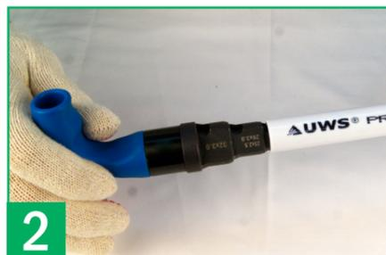
2 Для облегчения надевания трубы на штуцер соединителя и предотвращения от повреждения резиновых уплотнений с внутреннего слоя трубы снимается фаска под углом 15°.
