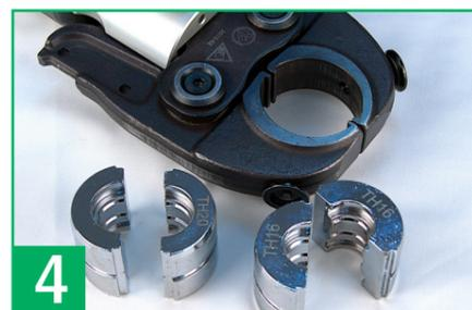
4 Опрессовка соединителей может производиться ручными или электрическими пресс-клещами. Пресс-вкладыши для фитингов должны иметь профиль типа «ТН». Использование насадок другого профиля недопустимо!
