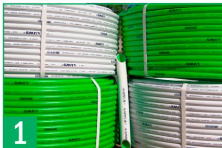
1 Если бухта металлопластиковой трубы хранилась на морозе-следует дать ей возможность вылежаться в течении 5 часов при температуре не менее 10°C, либо прогреть места соединений строительным феном (не более 50°C).
