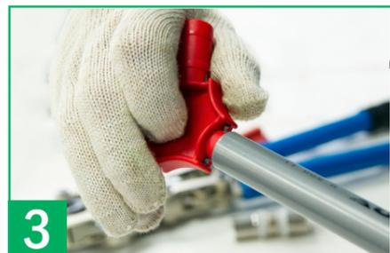
3 Для придания идеальной круглой формы сечению трубы следует калибровать трубу при помощи калибратора, а также одновременно снимать фаску. Калибровочный штырь вводится в трубу до упора и производится до 2-х оборотов относительно оси трубы.
