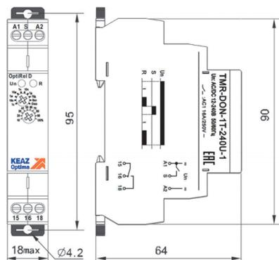
Рисунок А.1 – Габаритные и установочные размеры реле
