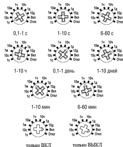
**Рисунок 3.4** – Диапазоны выдержки реле
