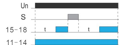
**Рисунок 3.3** – Функциональная диаграмма реле задержки включения с мгновенным контактом
