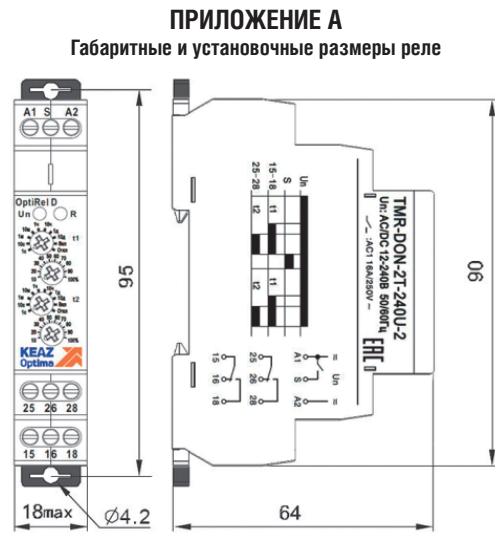
Рисунок А.1 – Габаритные и установочные размеры реле
