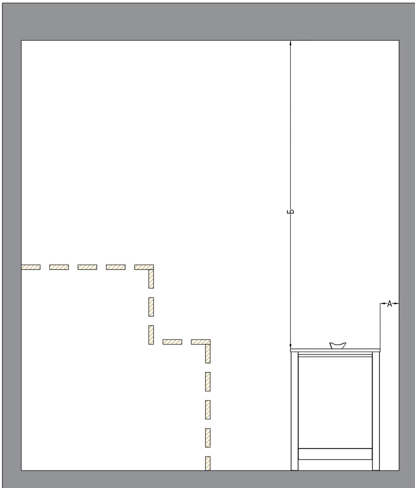
Рис. 13. Схема расположения печи в парной. Вид сбоку.
