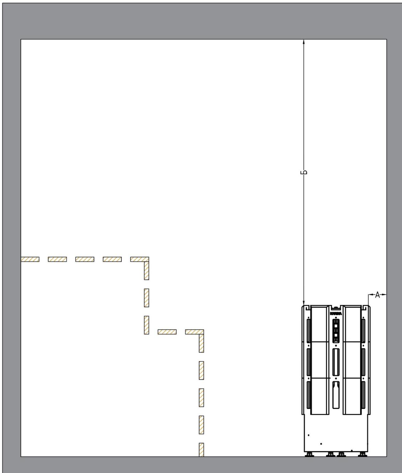
Рис. 19. Схема расположения печи в парной. Вид сбоку.
