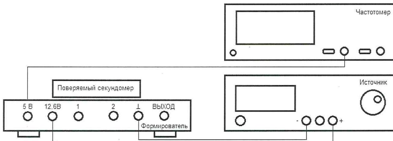
Частотомер – частотомер электронно-счетный АКПП-5102
