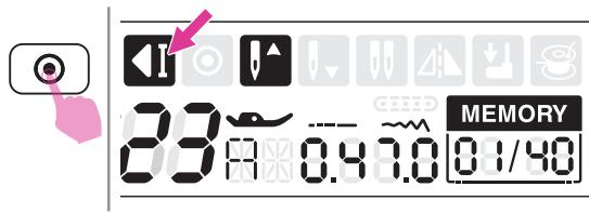
Если во время шитья нажать кнопку автоматической закрепки, машина выполнит 3 закрепляющих стежка по окончании текущей строчки и остановится. На экране отобразится символ автоматической остановки. При нажатии кнопки Вкл./Выкл. машина начнет шить со следующей строчки.
