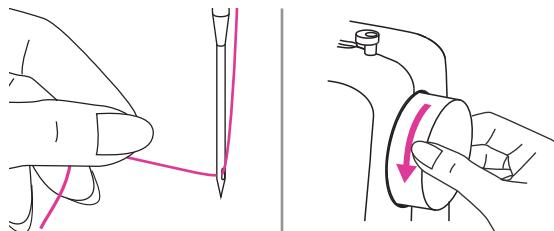
Придерживайте верхнюю нить левой рукой. Поверните маховое колесо на себя (против часовой стрелки), чтобы опустить иглу ниже уровня игольной пластины. Затем поднимите иглу, чтобы поднять шпульную нить.
