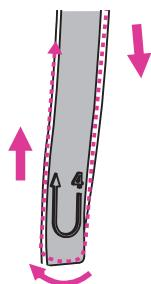
7. Проведите нить под пружиной нитепрятывателя, затем протяните ее наверх в направлении стрелок (см. рис.).
