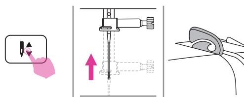
2. Нажмите кнопку подъема/ опускания иглы, чтобы поднять иглу и рычаг нитепрятывателя в крайнее верхнее положение.
