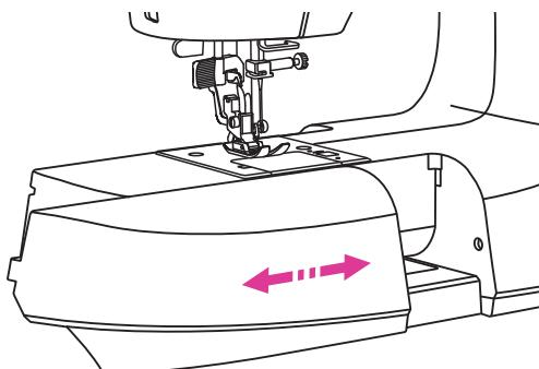
Удерживая съемный столик в горизонтальной плоскости, потяните его влево для отсоединения от машины.
