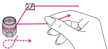
3. Обматывайте нить вокруг диска натяжения намотки шпульки по часовой стрелке.
