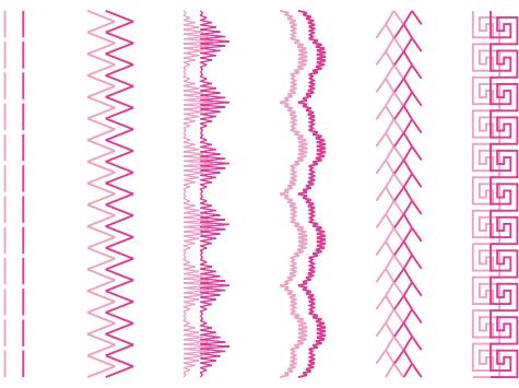
Две линии строчки выполняются параллельно друг другу.
