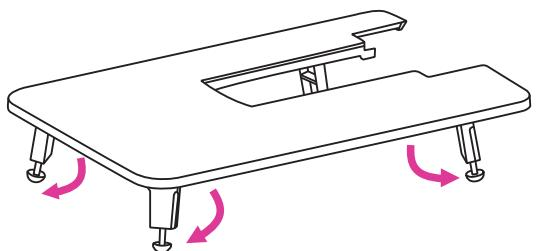
Для отсоединения съемного столика с отсеком для аксессуаров потяните его влево.
