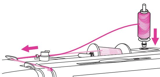
Следуйте инструкциям по заправке одиночной иглы с использованием горизонтального держателя катушки. Заправьте левую иглу.
