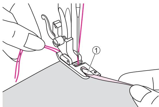
Поместите иглу в складку, повернув маховое колесо на себя, и опустите рычаг подъема прижимной лапки. Выполните несколько стежков и поднимите рычаг прижимной лапки.
