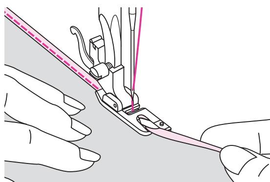
Опустите рычаг прижимной лапки и медленно начните шить, направляя необработанную кромку ткани впереди лапки для подгибы равномерно в спиральную прорезь лапки.
