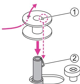
4. Протяните конец нити сквозь одно из внутренних отверстий в шпульке, как показано на рисунке, и наденьте ее на шпиндель для намотки шпульки. Совместите рискну на шпульке с пружиной шпинделя.
