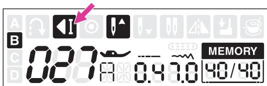
Для отмены повторного шитья следует нажать кнопку реверса. Машина выполнит 3 закрепляющих стежка после завершения одной полной комбинации. Во время выполнения последнего стежка на экране отобразится символ автоматической остановки.
