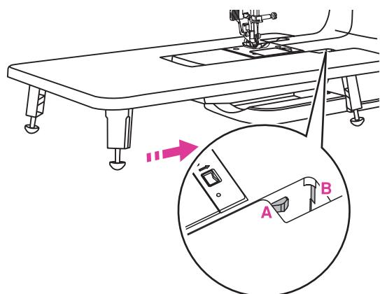
Для присоединения съемного столика совместите защелку (A) столика с гнездом (B) корпуса машины.
