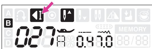
Во время работы машины: При выборе режима 6-9 из группы рабочих строчек или 001-007 или 021-105 из группы стандартных строчек и нажатой кнопке автоматической закрепки машина выполнит 3 закрепляющих стежка и автоматически остановится. Для отмены функции повторно нажмите кнопку во время шитья.
