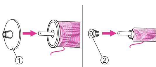
3. Наденьте катушку с нитками на катушечный стержень и закрепите ее при помощи держателя подходящего размера.
