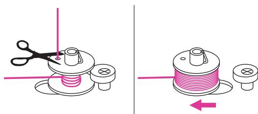
7. После намотки нескольких оборотов остановите машину и обрежьте конец нити как можно ближе к отверстию в шпульке. Продолжите процесс намотки, пока шпулька не заполнится. После заполнения шпульки ее вращение замедляется. Остановите машину, отпустив педаль или нажав кнопку Вкл./Выкл. Отведите шпиндель намотки шпульки влево.
