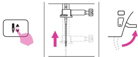
8. Нажмите кнопку подъема/ опускания иглы и поднимите иглу. Поднимите подъемный рычаг прижимной лапки и вытащите ткань.
