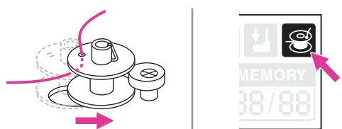
5. Отведите шпиндель намотки шпульки вправо. Когда шпиндель намотки шпульки отведен вправо, на экране отобразится указанный символ.
