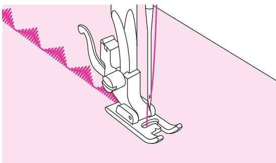
Лапка имеет паз на нижней поверхности, что позволяет плотной строчке свободно перемещаться под лапкой.
