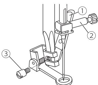
Снимите держатель прижимной лапки и установите лапку для штопки/ вышивки.
