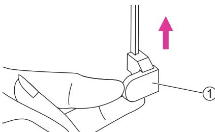
Поднимите рычаг подъема прижимной лапки и обрежьте нити. Для повторного обметывания той же петли поднимите рычаг подъема прижимной лапки, переместите ткань, опустите рычаг подъема прижимной лапки и начните шить.
