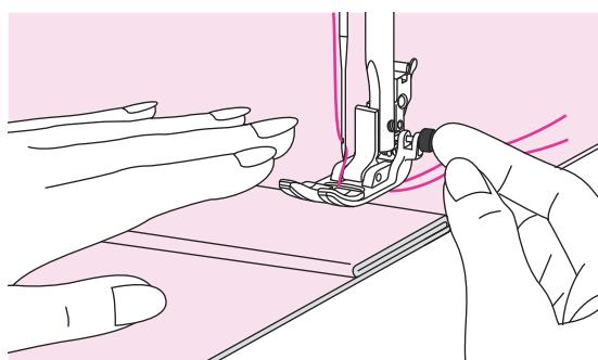
Когда достигнете точки наибольшего утолщения, опустите иглу и поднимите рычаг прижимной лапки. Выровняйте основание лапки горизонтально и нажмите черную кнопку. Затем опустите лапку и продолжите шитье.
