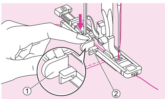
Опустите рычаг механизма обметывания петель вниз до упора и расположите его позади скобы на лапке для петель.
