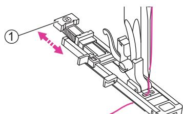
Выдвиньте держатель пуговиц и установите желаемый размер штопки. Установите ширину строчки и длину стежка в соответствии с желаемой шириной и плотностью.
