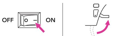
1. Переместите выключатель в положение «I». Поднимите рычаг прижимной лапки.
