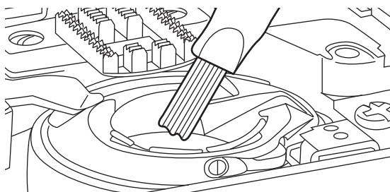
Очистите транспортер и шпульный колпачок при помощи кисточки и мягкой сухой ткани.
