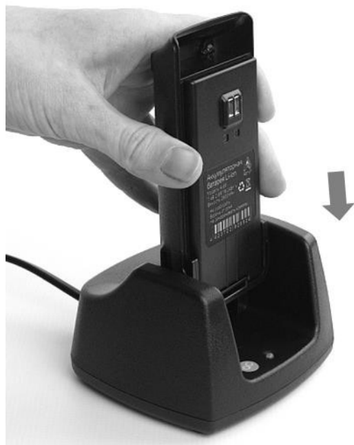
Рис. 7. Установка аккумуляторной батареи на зарядку.
