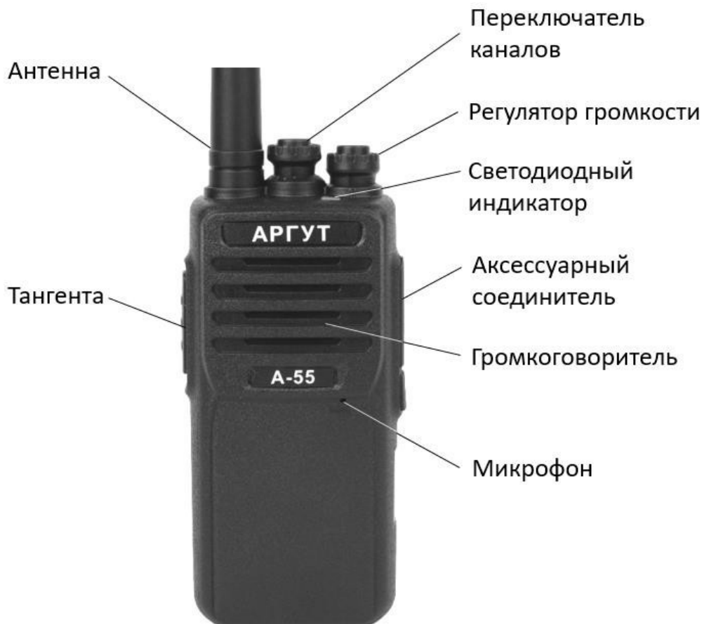
Рис. 1. Расположение органов управления, индикации и соединителей.
