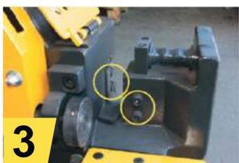
3. Проверьте затяжку винтов на ножах. Если винты ослаблены, их необходимо затянуть (см. рис. 3).
