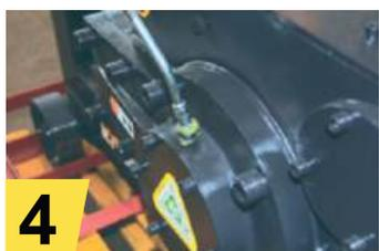
4. Для станков VPK P-40, VPK P-42, VPK P-52 через лубрикатор следует проширцевать смазкой типа «Литол» втулку скольжения коленчатого вала. Следует повторять процедуру 2-3 раза за рабочую смену (см. рис. 4).
