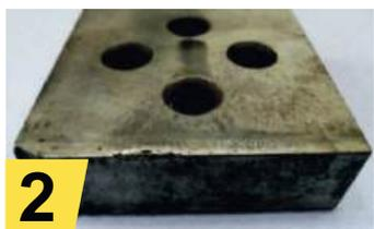
2. Проверьте состояние режущих кромок ножей. Если рабочая кромка изношена, то следует развернуть нож неизношенной кромкой и заменить нож (см. рис. 2).
