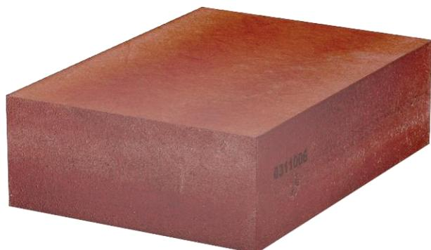
Мягкий, прочный эластичный пеноблок для кабельных и комбинированных проходов. Возможна продольная и поперечная установка для достижения различных классов огнестойкости. Может сочетаться с 2-компонентной огнестойкой пеной FBS S. Может использоваться в массивных потолках и стенах, а также в легких перегородках. Имеет маркировку Соответствует ТР ЕАЭС 043/2017 для применений с огнестойкостью до 240 минут.
