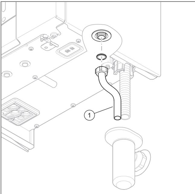
1. Установите сливную трубу (1), предохранительного клапана так, чтобы при снятии и надевании нижней части сифона она не мешала.
