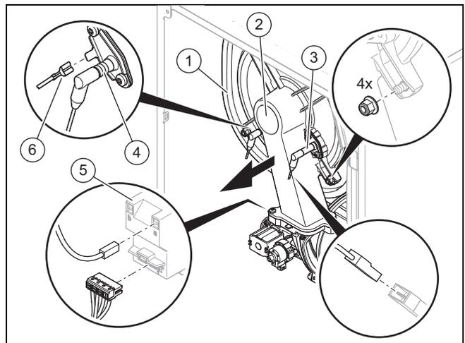
9. Отсоедините заземляющий кабель (6). электрода розжига (4).. два штекера трансформатора розжига (5).. и штекер кабеля регулирующего электрода (3)..
