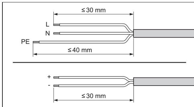
7. Удалите внешнюю оболочку с конца гибких кабелей, как показано на рисунке. При этом не допускайте повреждения изоляции отдельных жил.
