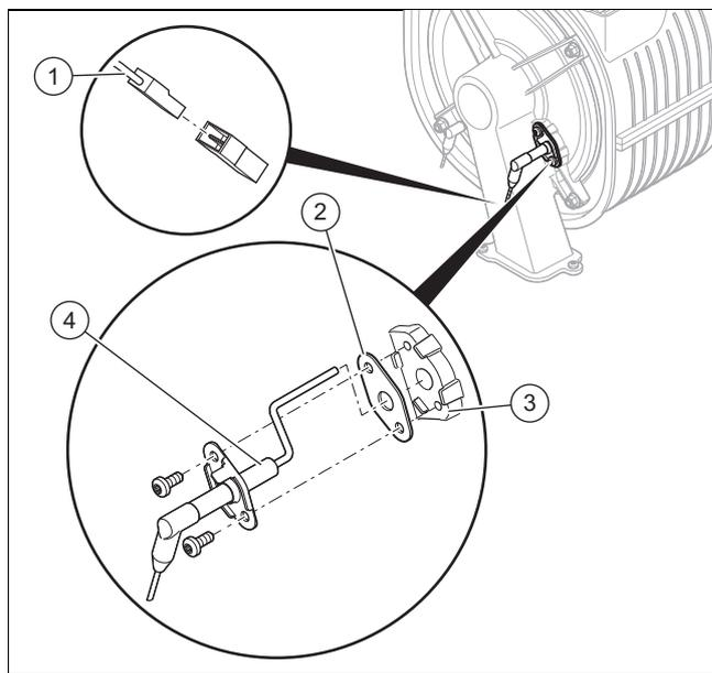
1. Отсоедините штекер (1). кабеля регулирующего электрода.
