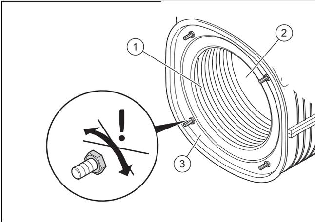
1. Очистите нагревательную спираль (1), теплообменника (3), водой или при необходимости раствором уксусной кислоты (макс. концентрация 5 %).
