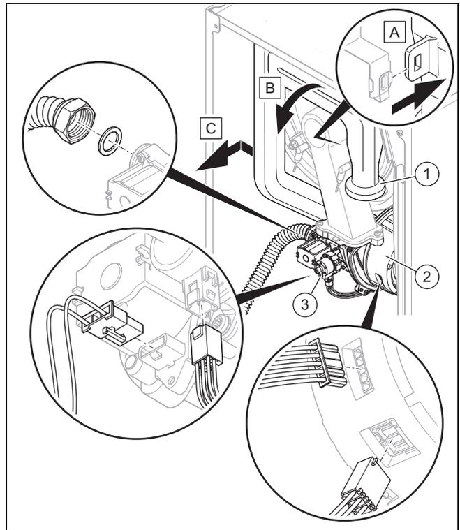
5. Выньте воздухозаборную трубу (1). из верхнего держателя и снимите её со всасывающего патрубка, как показано на рисунке.
