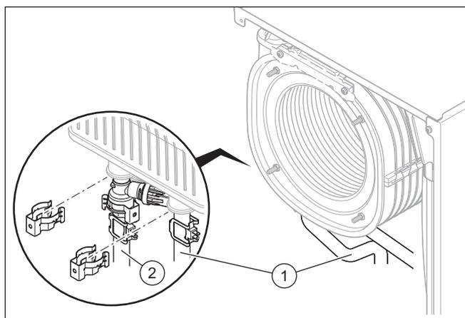
4. Снимите зажимы с трубы подающей линии (2) и трубы обратной линии (1)..
