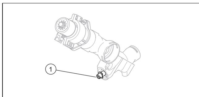
3. Отрегулируйте давление регулировочным винтом (1)..
