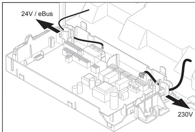
6. Проложите соединительные кабели подключаемых компонентов в распределительной коробке надлежащим образом.
