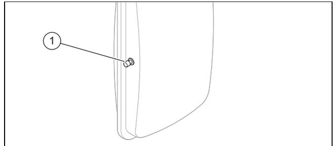
2. Проверьте давление на входе расширительного бака в зоне его вентиля (1)..
