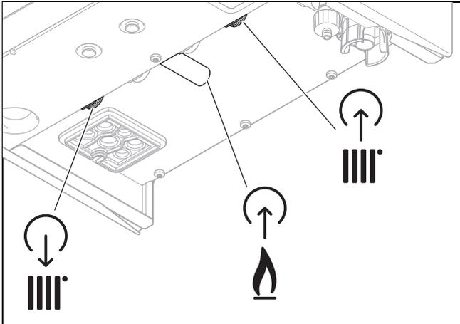
1. Выполните монтаж газовой трубы к газовому штуцеру без механических напряжений.
