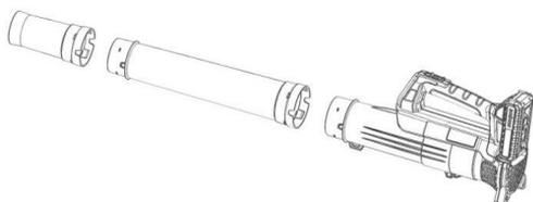
Для снятия трубы нажмите на фиксатор.
