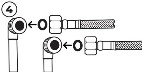
4 Подсоедините гибкую подводку к системе водоснабжения с использованием уплотнителей согласно ГОСТ Р70407-2022
