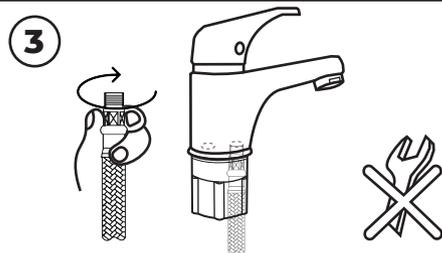
3 Вкрутите гибкую подводку (концевую арматуру затягивайте согласно ГОСТ Р70407-2022 без использования инструментов)
