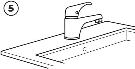
5 При первом пуске воды проверьте корпус и подводку на наличие протечек. В случае подтеканий подтяните соединительные гайки
