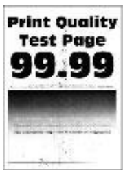
Печать покрыта пятнами и точками
