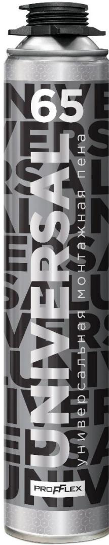
**UNIVERSAL 65** – профессиональная универсальная однокомпонентная полиуретановая пена, предназначенная для работы в диапазоне температур от -16 °C до +35 °C. Выход пены – до 65 литров. Наилучшие результаты достигаются при применении пены при температуре не ниже -12 °C.
