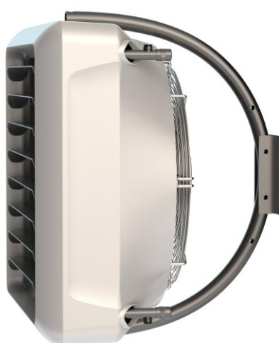
Корпус **EcoHeat** изготовлен из прочного, безопасного и экологически чистого АБС-пластика. Под корпусом находится медно-алюминиевый теплообменник высокой эффективности, а также малошумный осевой вентилятор с тремя режимами скорости. В комплектацию устройства EcoHeat также входит универсальный кронштейн для вертикальной и горизонтальной установки тепловентилятора.
