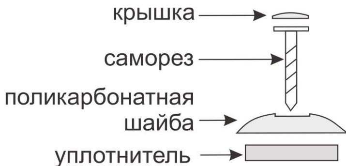
*диаметр отверстия должен быть на 2мм больше внешнего диаметра самореза*
