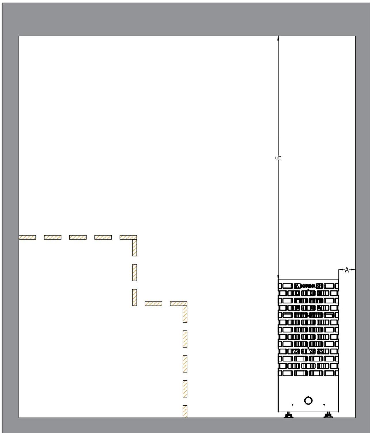
Рис. 12. Схема расположения печи в парной. Вид сбоку.
