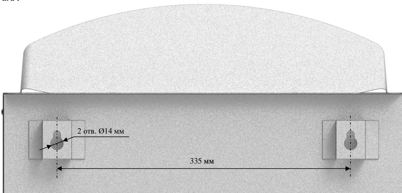
Рис. 14. Межосевое расстояние кронштейнов и размер посадочных отверстий печи.
