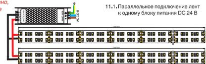
11.1. Параллельное подключение лент к одному блоку питания DC 24 В
