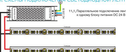
11.1. Параллельное подключение лент к одному блоку питания DC 24 В
