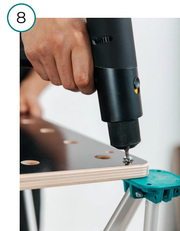
8 С помощью ключа (идет в комплекте) или шуруповерта прикрутите столешницу к подстолью.
