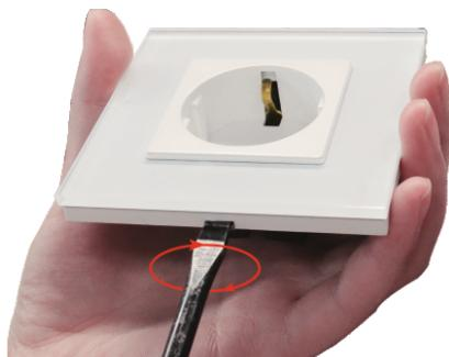
Для того, чтобы отделить стеклянную панель и металлическую рамку друг от друга используйте плоскую отвертку. Нужно подставить конец отвертки в паз снизу и повернуть.
