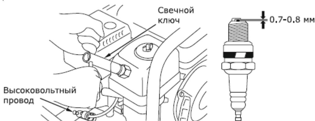
Поместите шайбу на свечу зажигания и закрутите ее таким образом, чтобы избежать завинчивания с перекосом.
