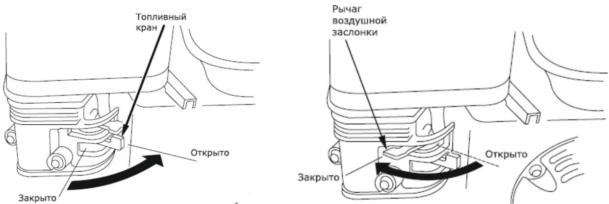
**⚠ ВНИМАНИЕ!** Если двигатель горячий, нет необходимости закрывать воздушную заслонку. Никогда не давайте работать двигателю длительное время при закрытой воздушной заслонке. Это приведет к поломке двигателя и снятию с гарантии.
