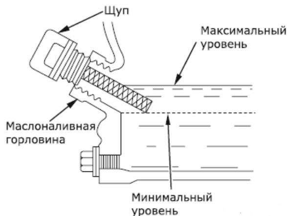
Выкрутите крышку маслозаливной горловины и протрите измерительный щуп. Введите щуп в масляный патрубок, но не закручивайте его. Извлеките щуп и посмотрите текущий уровень масла в картере.
