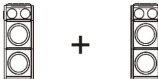
Данная модель поддерживает воспроизведение беспроводного объемного стереозвука (True Wireless Stereo (TWS)). Чтобы использовать данную функцию вам потребуются две мидисистемы данной модели, между которыми нужно установить соединение Bluetooth.
