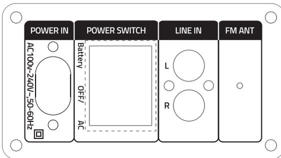
1. **POWER IN** Разъем для подключения кабеля питания
