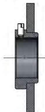
Рис. 2 Пуансоны основного комплекта и центрирующие кольца люнета
