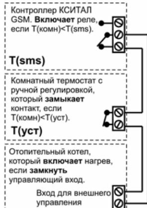
При таком подключении КСИТАЛ-GSM поддерживает дистанционно задаваемое значение температуры **ниже** установленной на автономном термостате (см. раздел "Задание температуры, автоматически поддерживаемой в помещении").
