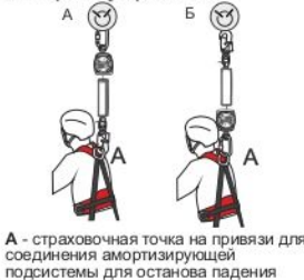
Рис. 5. Общие принципы использования карабинов
