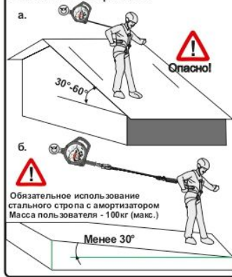
Рис. 12. Вытягивание и втягивание троса
