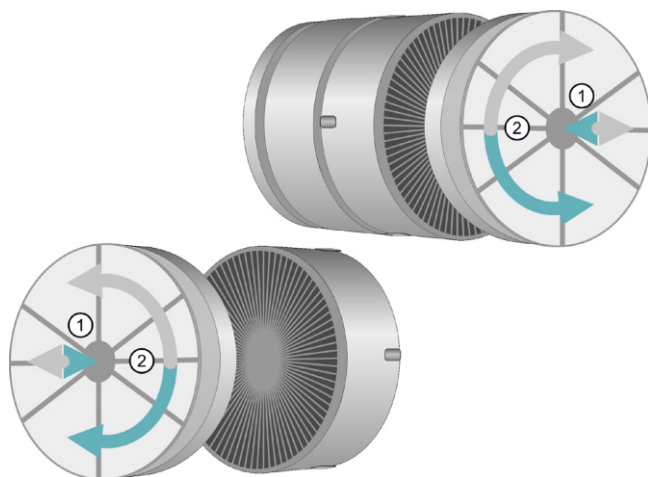
Рис. 14 Установка угольного фильтра
