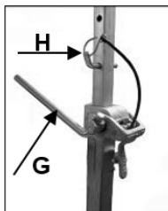
Plaats de boorinstallatie op de gewenste plek. Plaats de snelsteuneenheid zo dicht mogelijk achter de ondersteuning op de basis van de installatie. Bevestig de boorinstallatie door de arm (G) rechtsom te draaien. Zet het vast in positie d.m.v. de daarvoor bestemde bout (H).
