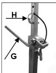
Positionieren Sie den Bohrständer. Setzen Sie die Schnellspannsäule so dicht wie möglich hinter der Säule auf dem Ständerfuß auf. Fixieren Sie den Bohrständer durch Drehen der Kurbel (G) im Uhrzeigersinn. Sichern Sie die Einstellung mit dem dazugehörigen Bolzen (H).
