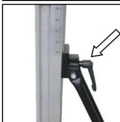
Der Klemmhebel an der Abstützung ist zu lösen. Bringen Sie die Säule in den entsprechenden Winkel und ziehen Sie die beiden Schrauben und den Klemmhebel wieder fest an.
