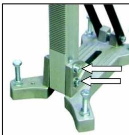
Lösen Sie die beiden Innensechskantschrauben M 10 mit dem beiliegenden Schlüssel SW 8.
