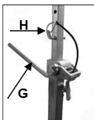
Coloque el soporte del taladro. Sitúe la unidad de soporte de acción rápida lo más cerca posible por detrás del soporte en la base. Fije el soporte girando el eje (G) en el sentido de las agujas del reloj. Fije la posición con el perno apropiado (H).
