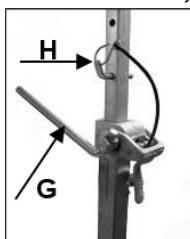
Posizionate il supporto. Mettete la colonna a serraggio rapido quanto più vicino possibile dietro la colonna sulla base del supporto. Fissate il supporto girando la manovella (G) in senso orario. Assicurate l'impostazione con il corrispettivo bullone (H).
