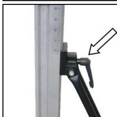
Afloje la palanca de sujeción del soporte.
