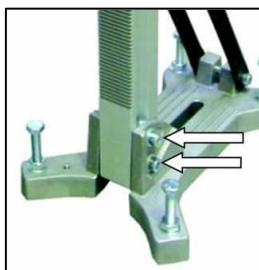
Afloje los dos tornillos de hexágono interior M 10 con la llave SW 8 adjunta.
