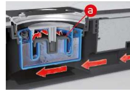
При возникновении избыточного давления в отводящем трубопроводе тарелка клапана (а) прижимается к корпусу и не пропускает запахи из канализации.
