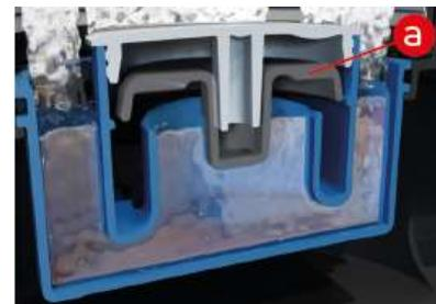
Когда вода стекает в корпус трапа, тарелка клапана (а) поднимается вместе с уровнем воды.
