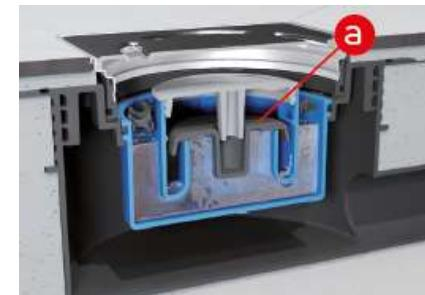
Когда слив воды прекращается, то тарелка клапана (а) опускается на корпус клапана и не пропускает запахи из канализации.
