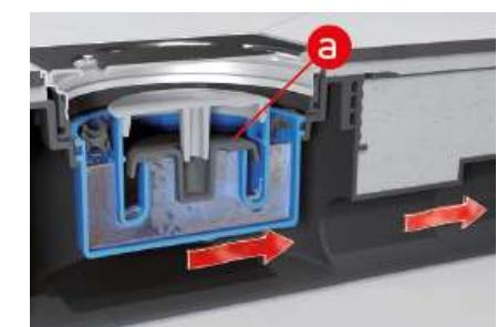
При возникновении разрежения в канализационных трубопроводах, тарелка клапана (а) под собственным весом прижимается к корпусу и препятствует высасыванию воды из сифона.
