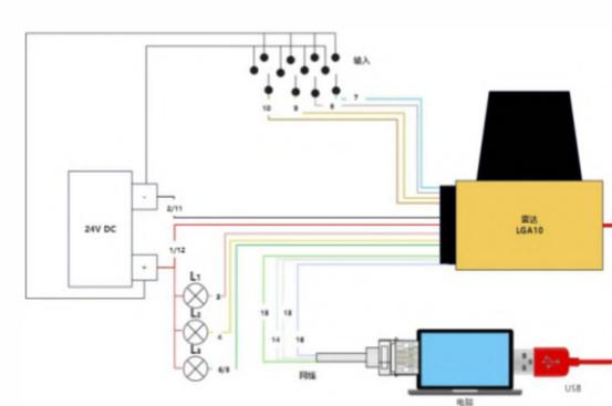
Схема подключения NPN
