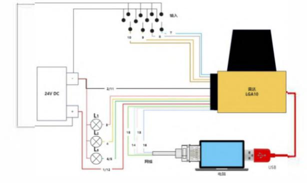
Схема подключения PNP
