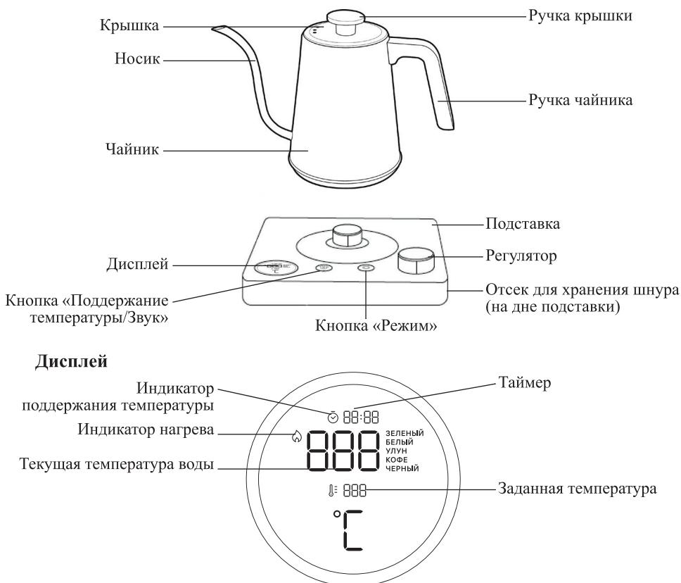
**Регулятор** служит для включения и отключения чайника, а также для выбора температуры нагрева от 40 до 100 °С с шагом 1 °С, режима и времени поддержания температуры. Нажатие на регулятор включает и отключает чайник. Поворот регулятора изменяет настраиваемый параметр.
