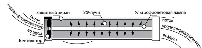
Рециркулятор является облучателем закрытого типа, в котором бактерицидный поток от ультрафиолетовой лампы распределяется в небольшом замкнутом пространстве. В зоне облучения применены материалы, обладающие высокими отражающими свойствами, обеспечивающие эффективную бактерицидную обработку воздушного потока (отражающая способность УФ-излучения не менее 75 %).
