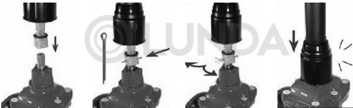
Рис. 4 Порядок установки телескопического штока на задвижку.
